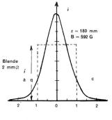
Fig. 2. Stromdichteverteilung in verschiedenen Strahlquerschnitten und äquivalente mittlere Stromdichte  $i_{\bar{a}q}$ . Bei a) ausgeprägter Strahlmantel [29]
