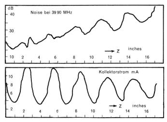
Fig. 9. Rauschanstieg bei optimaler Phasenlage und zugehöriger Kollektorstrom nach [6]. Blendendurchmesser 0,1 inch, Frequenz 3990 MHz, U=2200 V,  $I\ldots=38$  mA, B=135 B
