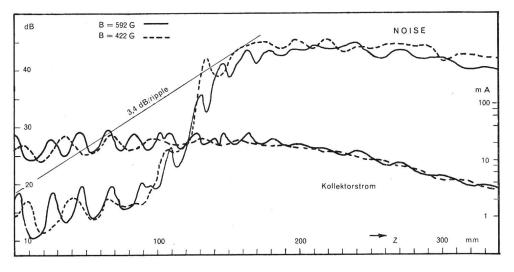
Fig. 6. Typische Rauschkurve für U=2000 V, I...=90 mA, Blenden-öffnung 1 mm Durchmesser, Vorspannung der Kathodenblende -15 V. Shot-Noise-Niveau 21,5 dB
