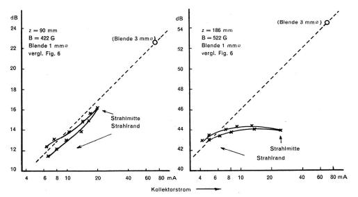
Fig. 12. Verteilung der Rauschleistung über den Strahlquerschnitt
