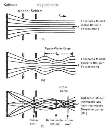
Fig. 1. Elektronenbahnen nach der laminaren und optischen Theorie
