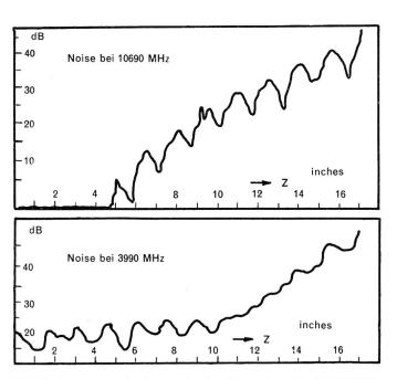
Fig. 10. Rauschanstieg bei optimaler Phasenlage für 10 690 MHz mit zugehöriger Rauschkurve für 3990 MHz nach [6]. U=2200 V,  $I\ldots=38$  mA, B=260 G
