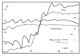
Fig. 8. Rauschkurve einer stark inhomogenen Kathode für U=2000 V, I... = 86...89 mA, Vorspannung der Kathodenblende –20 V, Magnetfeld B=422 G. Shot-Noise-Niveau 27 dB
