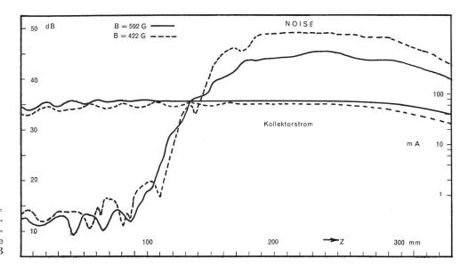
Fig. 7. Typische Rauschkurve für U=2000 V,  $I\ldots=89$  mA, Blendenöffnung 3 mm Durchmesser, Vorspannung der Kathodenblende -10 V. Shot-Noise-Niveau 19 dB
