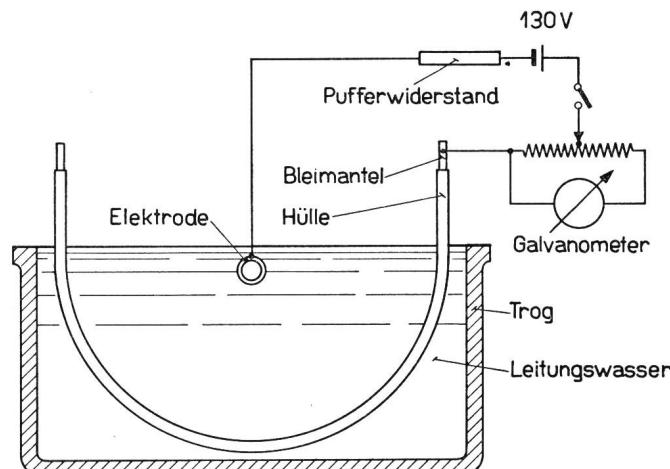
Fig. 1. Schema der Messanordnung
