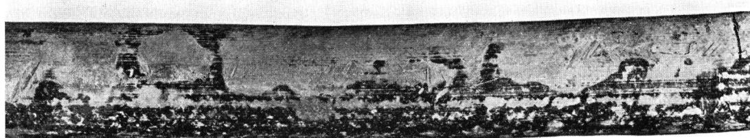
Fig. 13. Zustand des Bleimantels nach dem Dauerversuch am Muster Nr. 10c, Schrumpfschlauch
