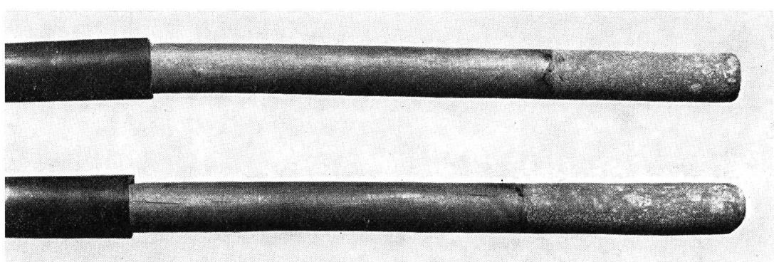
Fig. 19. Zustand der Bleimäntel nach dem Dauerversuch an den Mustern Nr. 3 und 17, Polythen
