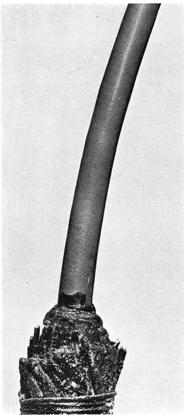
Fig. 16. Zustand des Bleimantels nach dem Dauerversuch am Muster Nr. 1, «Polyment»
