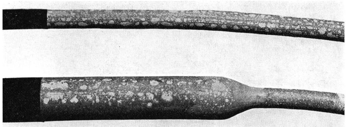
Fig. 15. Zustand der Bleimäntel nach dem Dauerversuch an den Mustern Nr. 25a und 25b, «Duralon»
