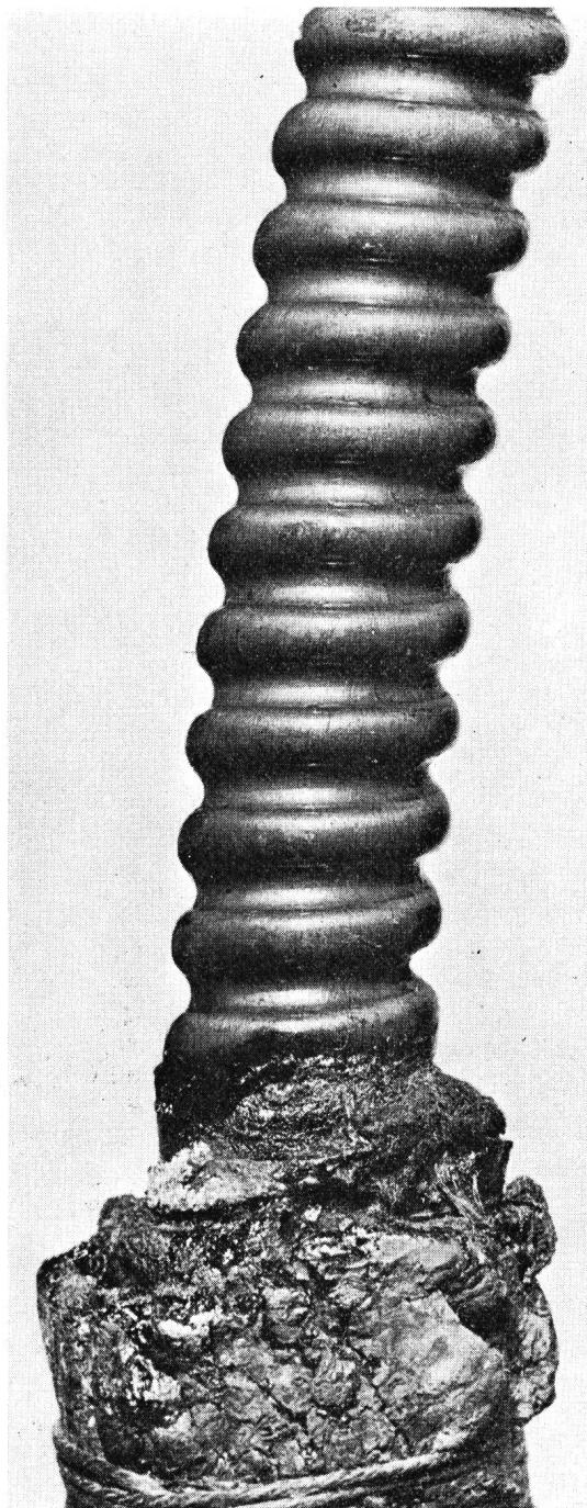
Fig. 17. Zustand des Wellstahlmantels nach dem Dauerversuch am Muster Nr. 2, «Polyment»
