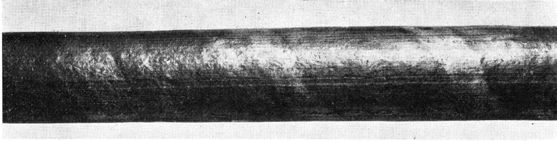
Fig. 18. Zustand des Bleimantels nach dem Dauerversuch am Muster Nr. 4, «Sandwich»
