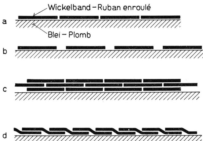
Fig. 4. Schema der Bandwicklungen
