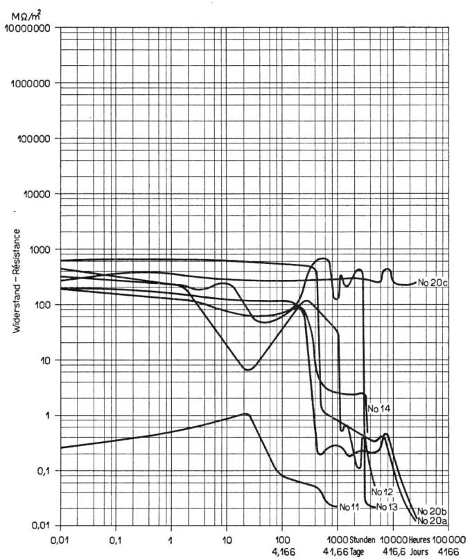
Fig. 7. Verlauf des Isolationswiderstandes im Dauerversuch
