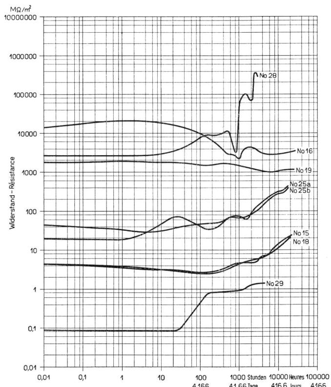
Fig. 8. Verlauf des Isolationswiderstandes im Dauerversuch
