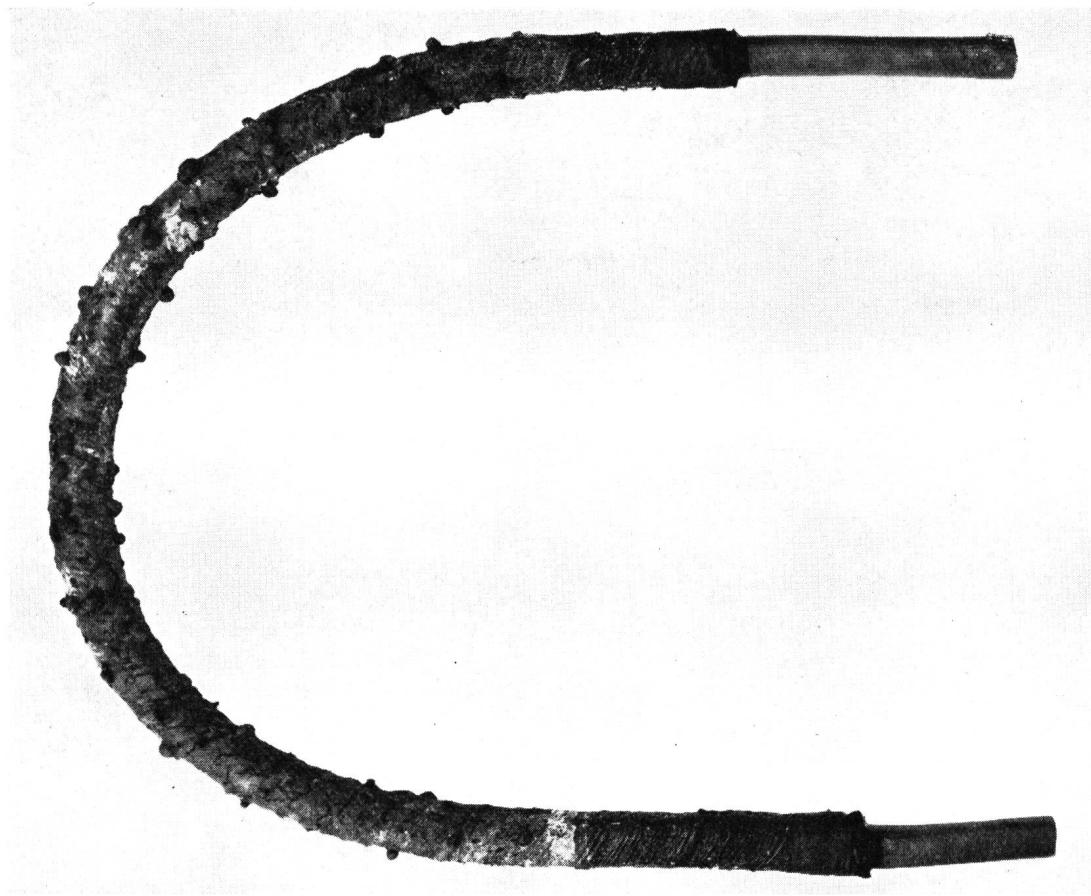
Fig. 22. Zustand der Hülle nach dem Dauerversuch am Muster Nr. 4, «Sandwich»
