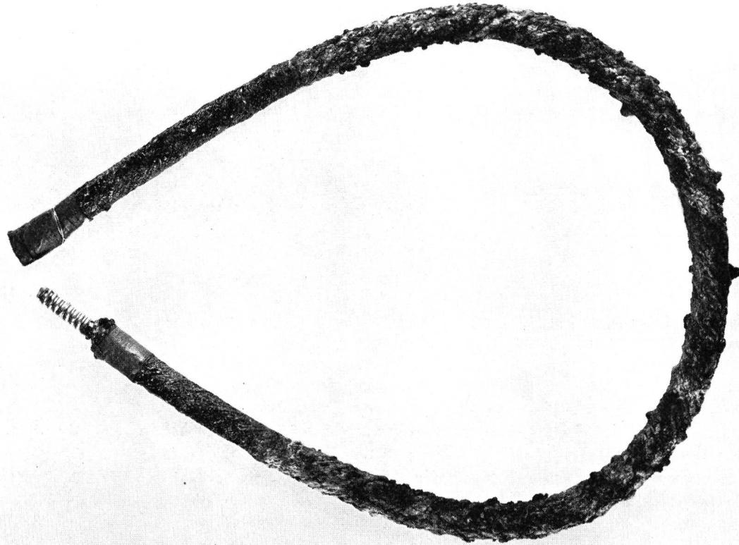
Fig. 21. Zustand der Hülle nach dem Dauerversuch am Muster Nr. 2, «Polymet»
