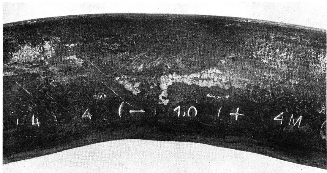
Fig. 11. Zustand des Bleimantels nach dem Dauerversuch am Muster Nr. 10a, Schrumpfschlauch
