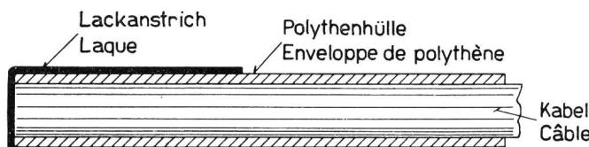
Fig. 5. Mit «Duralon»-Lack hergestellter Endverschluss
