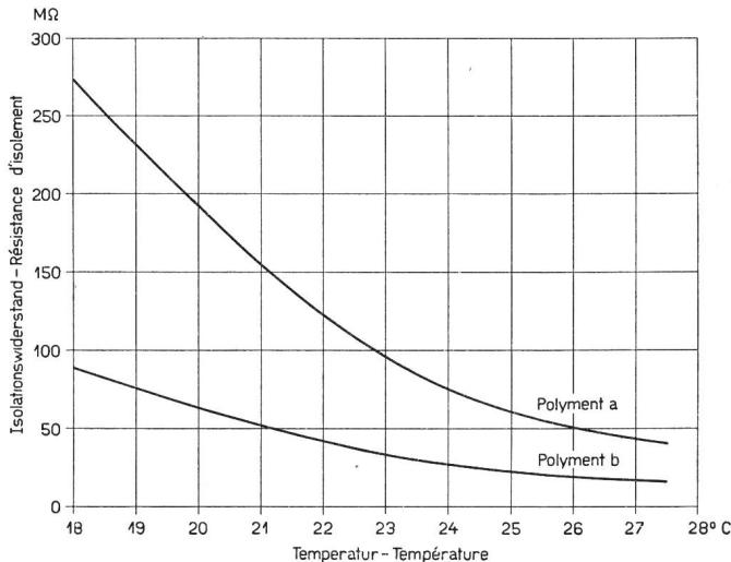
Fig. 2. Abhängigkeit des Isolationswiderstandes der «Polyment»-Hüllen von der Temperatur
