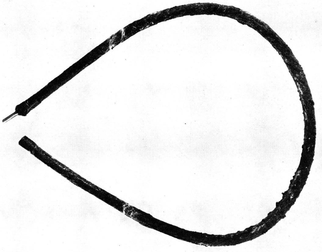
Fig. 20. Zustand der Hülle nach dem Dauerversuch am Muster Nr. 1, «Polyment»
