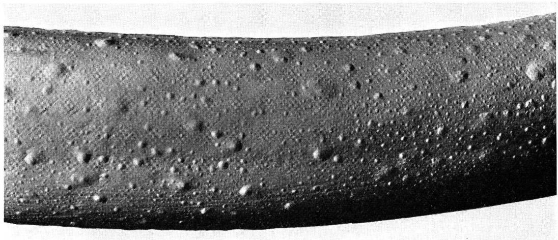
Fig. 24. Zustand der Hülle nach dem Dauerversuch am Muster Nr. 24, «Vinyl-Clad»
