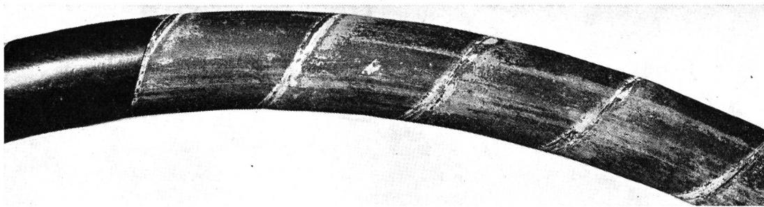
Fig. 10. Zustand des Bleimantels nach dem Dauerversuch am Muster Nr. 13, «Scotchband»
