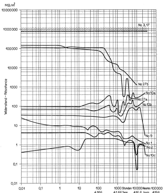
Fig. 9. Verlauf des Isolationswiderstandes im Dauerversuch
