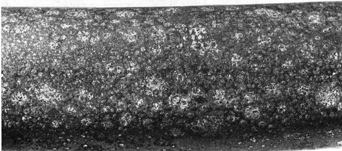
Fig. 14. Zustand des Bleimantels nach dem Dauerversuch am Muster Nr. 24, «Vinyl-Clad»
