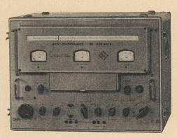
VHF-Grossempfänger Typ ESG 30-330 MHz
