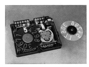
Fig. 1. Nummernanzeigesystem in Personensuch-Tableau, ohne Verschalung
