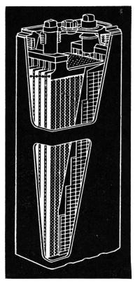
Fig. 4. Aufbau der Electrona-Dural-Batterie
