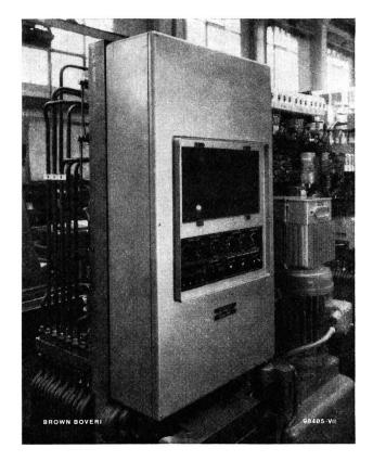
Fig. 5. Elektronische Programmsteuerung an einem Kopierfräsautomaten
