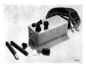
Fig. 2. Dosimeter mit Ladeablesegerät zum Schutz von Einzelpersonen gegen unerwartet auftretende anomale Aktivitäten
