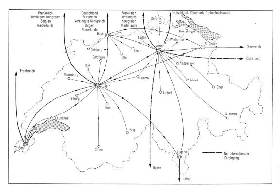
Fig. 2. Halbautomatische Anschalteleitungen
