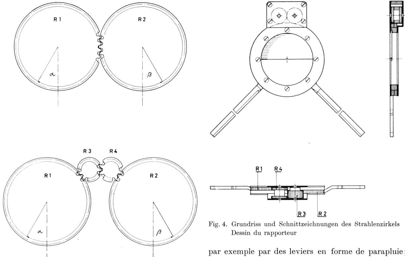
Fig. 3.  $R_1, R_2$  gleich grosse, verzahnte Primärräder
