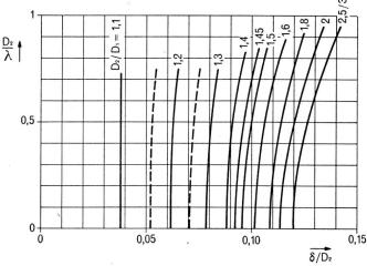
Fig. 7. Abhängigkeit des optimalen Wertes der Kompensationslänge  $\delta/D_2$  von der Frequenz mit dem Sprungverhältnis  $D_2/D_1$  als Parameter. Die Genauigkeit der angegebenen  $\delta/D_2$ -Werte beträgt etwa  $\triangle$   $(\delta/D_2) \subseteq 0,002$
