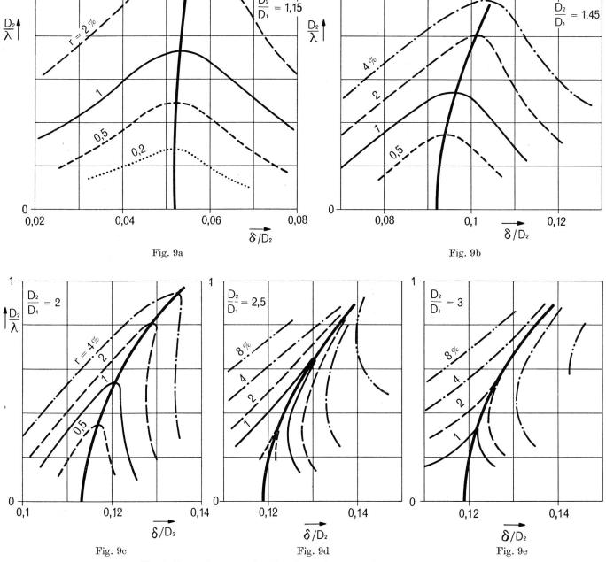
Fig. 9. Restreflexion in der Umgebung der optimalen Dimensionierung
