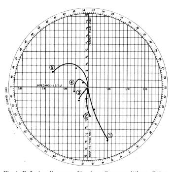
Fig. 4. Reflexionsdiagramm für einen Sprung mittlerer Grösse mit  $D_2/D_1=1,45$ . Parameter der Darstellung ist die Verschiebung  $\delta/D_2$  mit den Werten:  $\delta/D_2=0,69$ ; 0,86; 0,98; 1,035; 1,21 für die Kurven 1...5. Die angegebenen Messpunkte entsprechen den relativen Frequenzen  $D_2/\lambda=0,39$  und 0,77. (Aus Gründen der Übersichtlichkeit wurde nur ein kleiner Teil der Messpunkte eingezeichnet)
