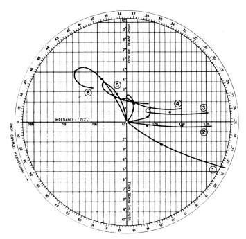
Fig. 5. Reflexionsdiagramm für den grossen Sprung  $D_2/D_1=3$ . Die Kurven 1...6 haben die Parameter:  $\delta/D_2=0,108$ ; 0,117; 0,121; 0,125; 0,129; 0,137 und die angegebenen Messpunkte entsprechen den Frequenzen  $D_2/\lambda=0,33$  und 0,6
