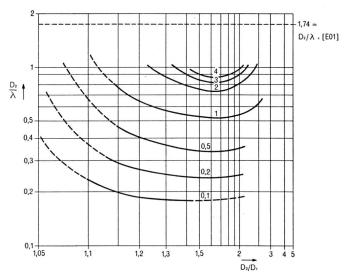
Fig. 8. Nicht kompensierbare, minimale Restreflexionen für die optimale Kompensationslänge in Funktion des Sprungverhältnisses und der Frequenz. (Genauigkeit der angegebenen Reflexionswerte  $\triangle r/r \leq 10...30\%$  bei grossen... kleinen Reflexionen)
