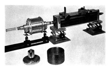
Fig. 3. Messapparatur zur Bestimmung der Reflexionen
