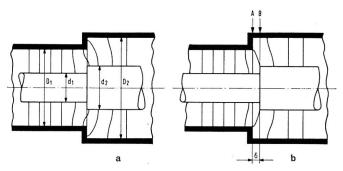
Fig. 1. Koradialer (a) und kompensierter radialer (b) Sprung im koaxialen Leiter. Die Verzerrung des Feldlinienbildes an der Sprungstelle ist ersichtlich
