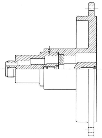
Fig. 2. Schnitt durch den verwendeten Übergang auf den Messguerschnitt
