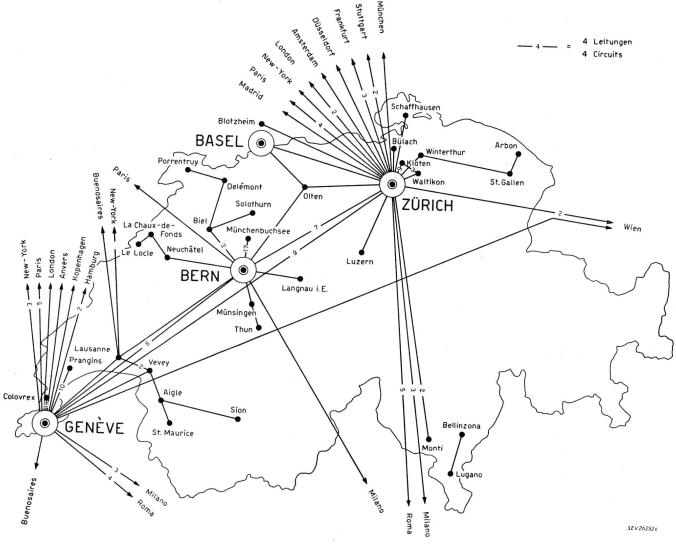
Fig. 4. Carte schématique des circuits loués
