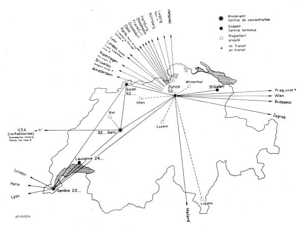
Fig. 3. Carte schématique du réseau télex
