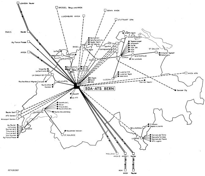
Fig. 17. Carte schématique du réseau de l'Agence Télégraphique Suisse (ATS) Abonnés de l'ATS Liaisons télex régulières Réseau simultané de l'ATS Offices télégraphiques Télex
