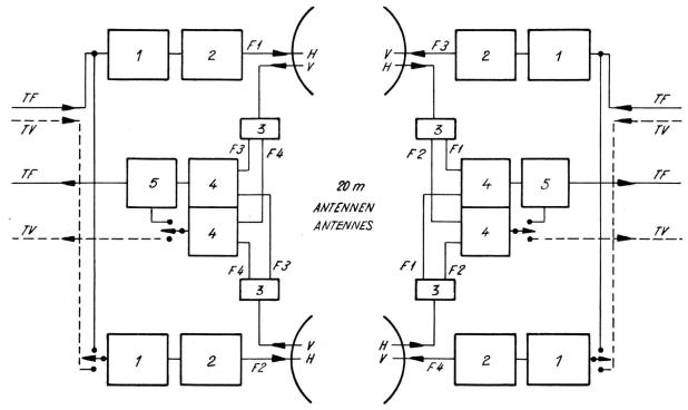
Fig. 4. Prinzipschema des Vierfach-Diversity-Richtstrahlsystems Florida-Kuba Schéma de principe de la «diversity» quadruple du système hertzien Floride-Cuba
