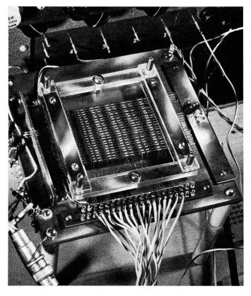
Fig. 4. Der Twistor (Versuchsanordnung
