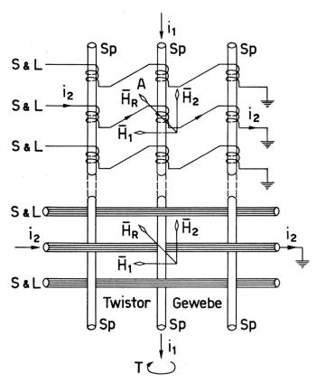
Fig. 2. Schematischer Aufbau eines Informationsspeichers mit Twistor-Gewebe
