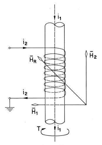
Fig. 1. Schematischer Aufbau eines Informationsspeichers  $\overline{H}_1 = Zirkulares Magnetfeld des Stromes i_1 im Nickelleiter <math>\overline{H}_2 = Axiales Magnetfeld des Stromes i_2 in der Kupferspule <math>\overline{H}_R = \overline{H}_1 + \overline{H}_2 = Resultierendes Speicherfeld$  T = Mechanische Verdrehung (Torsion) des Nickeldrahtes
