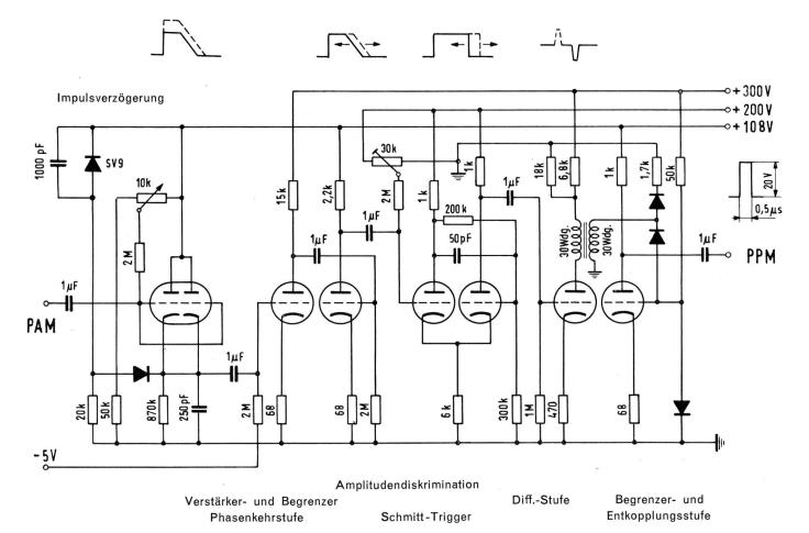
Fig. 14. Schema des PAM-PPM-Umwandlers
