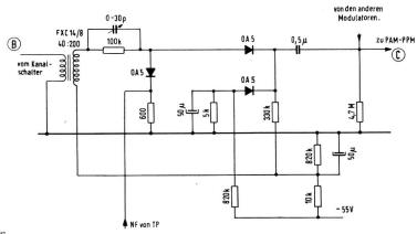
Fig. 12. Schema des Amplitudenmodulators
