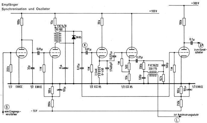
Fig. 18. Schema der Synchronisation des Empfängers
