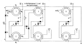
Fig. 9. Schema des Kanalschalters
