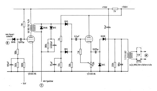
Fig. 20. Schema der Demodulation
