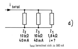
Fig. 10. Berechnung des zur Aussteuerung des Kanalschalters notwendigen Stromes
