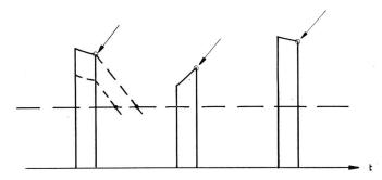
Fig. 5. PPM-Zeitmultiplex. Umwandlung der amplitudenmodulierten Impulse in lagemodulierte mittels einer Verzögerungsschaltung
