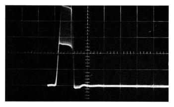
Fig. 13. Amplitudenmodulierter Impuls
