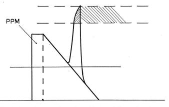
Fig. 6. Zurückverwandlung des zeitlagemodulierten Impulses in einen amplitudenmodulierten Impuls
