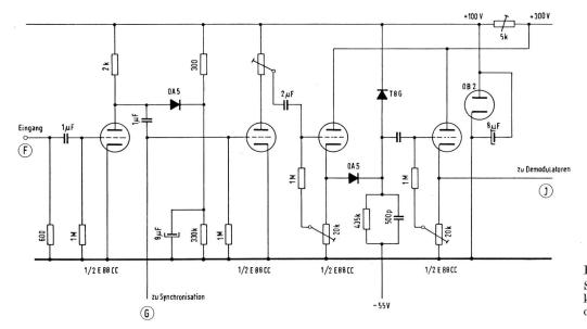
Fig. 17. Schema des Eingangsverstärkers und des Peakwert-Speichers
