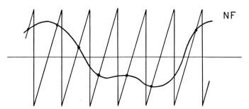
Fig. 3. Erzeugung einer phasenmodulierten Impulsfolge mittels Koinzidenz mit einer Sägezahnfunktion
