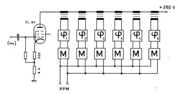
Fig. 4b. Prinzip eines Puls-Phasen-Modulations-Systems mit sechs Kanälen
