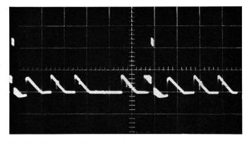
Fig. 21. Zur Demodulation aufgesetzte Impulse. (Man beachte die Amplitudenmodulation.)
