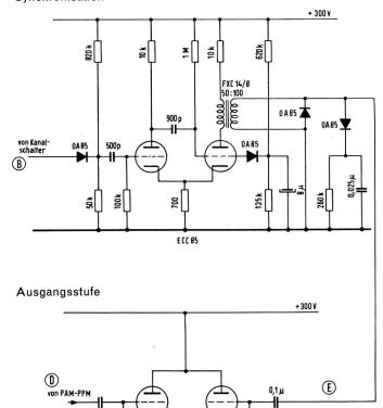
Fig. 15. Schema der Erzeugung des Synchronimpulses
