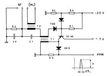
Fig. 4a. Schaltung eines einzelnen Modulators
