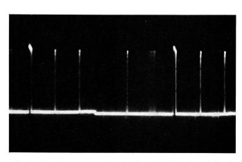
Fig. 7. Impulsprogramm des Senders (ein Kanal moduliert)
