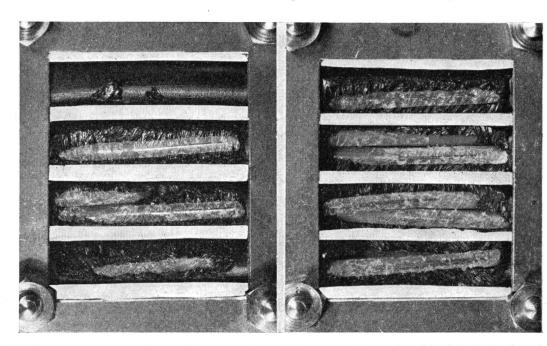
Fig. 4 und 5. Kabelstücke mit Polyäthylen- und Polyvinylchlorid-Isolation von einer Waldmaus angenagt
