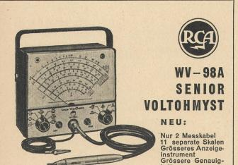
Misst direktanzeigend komplexe Spitzenspannungen Flacher Frequenzgang von 30 Hz-3 MHz Gleichspannung von 0-1500 V in 7 Bereichen Wechselspannung von 0-1500 V in 7 Bereichen Ohmmeter 0-1000 Megohm in 7 Bereichen Eingangswiderstand 11 Megohm auf allen Bereichen Anzeigeinstrument elektronisch geschützt Genauigkeit + 3 % bei Gleich- und Wechselspannung Erweiterung des Frequenzbereiches bis 250 MHz mit Kristalldiode WG-301A
