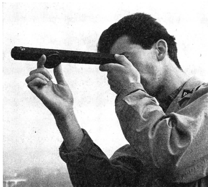
Fig. 7a. Mesure de la distance des conducteurs Messung der Leiterentfernung
