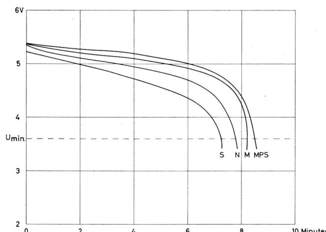
Fig. 8. Warmstartvermögen. Entladespannungen bei kontinuierlicher Entladung
