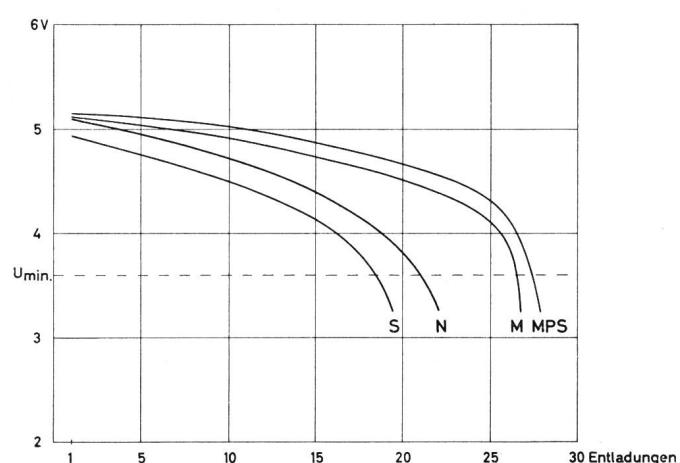
Fig. 9. Warmstartvermögen. Entladespannungen bei intermittierender Entladung
