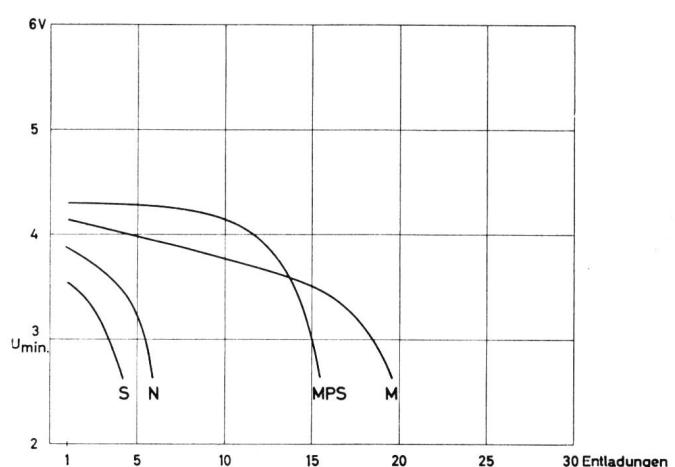
Fig. 11. Kaltstartvermögen. Entladespannungen bei intermittierender Entladung
