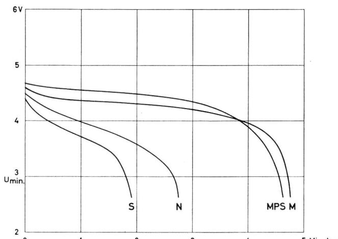
Fig. 10. Kaltstartvermögen. Entladespannungen bei kontinuierlicher Entladung
