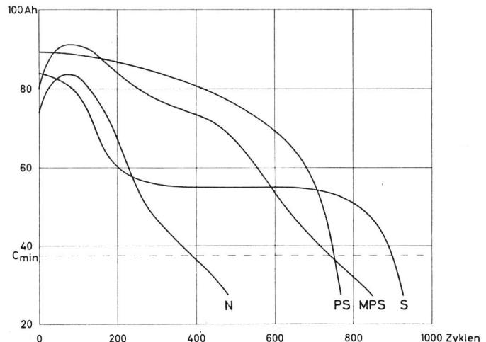
Fig. 12. Lebensdauerversuch. Verlauf der Kapazitätswerte
