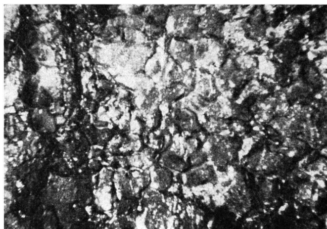
Fig. 13. Versuch mit 1000fach verdünnter Hellerscher Lösung. Deutlich interkristallin korrodierte Stelle der Innenwand. Vergrösserung 30 ×
