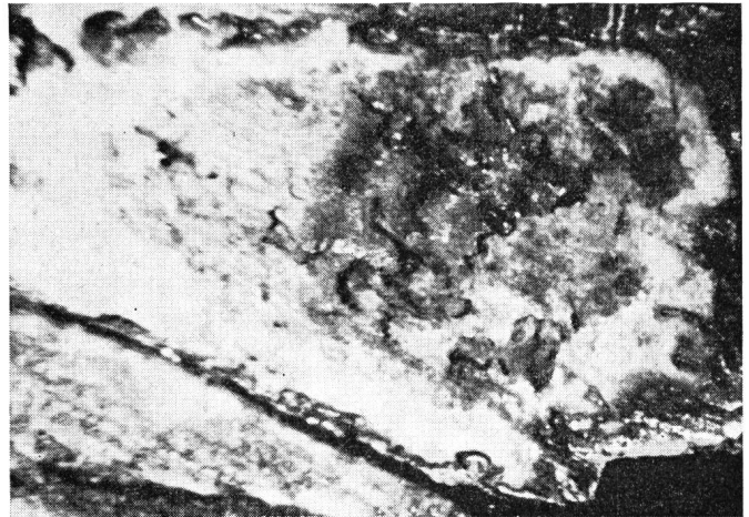
Fig. 17. Versuch mit destilliertem Wasser. Eine kleine Korrosionsstelle ist fast gänzlich von einer Schicht weissen Korrosionsprodukts verdeckt. Vergrößerung 30 ×
