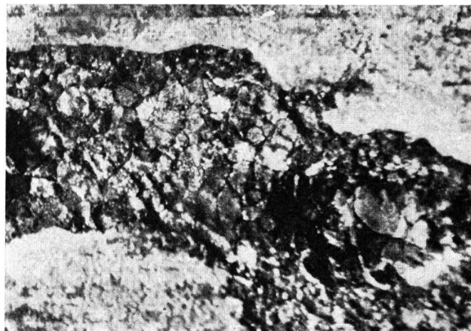
Fig. 12. Versuch mit 1000fach verdünnter Hellerscher Lösung. Neben der stark interkristallin korrodierten Furche, ist die Bleioberfläche (Aussenseite) noch unversehrt. Vergrösserung 30 ×
