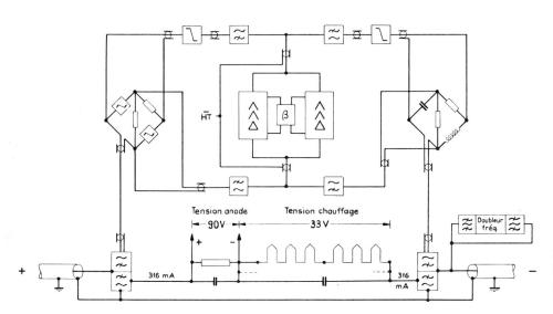
Fig. 12. Schéma simplifié du répéteur sousmarin bidirectionnel, type Clarenville— Sydney Mines
