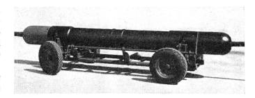
Fig. 17. Répéteur bidirectionnel, type Clarenville-Sydney Mines
