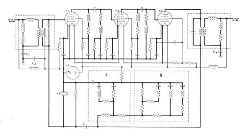
Fig. 6. Schéma du répéteur unidirectionnel type Clarenville-Oban
