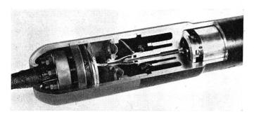
Fig. 11. Détails de construction de l'enveloppe du répéteur
