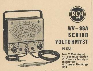
Misst direktanzeigend komplexe Spitzenspannungen Flacher Frequenzgang von 30 Hz – 3 MHz Gleichspannung von 0–1500 V in 7 Bereichen Wechselspannung von 0–1500 V in 7 Bereichen Ohmmeter 0–1000 Megohm in 7 Bereichen Eingangswiderstand 11 Megohm auf allen Bereichen Anzeigeinstrument elektronisch geschützt Genauigkeit + 3 % bei Gleich- und Wechselspannung Erweiterung des Frequenzbereiches bis 250 MHz mit Kristalldiode WG–301A
