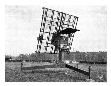
Fig. 4. Einstandortpeiler mit dazugehörender Radiosonde
