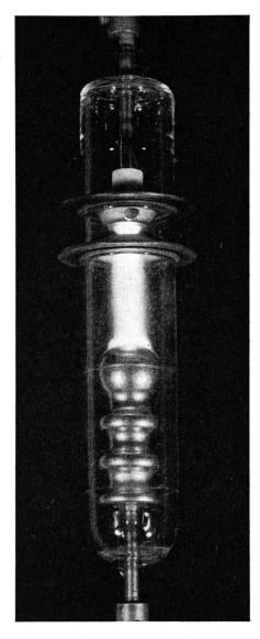
Fig. 3. Leistungs-Schaltröhre mit kalter Kathode in gezündetem Zustand
