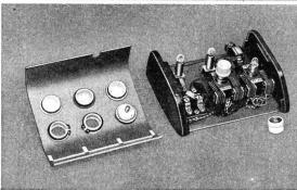
Fig. 2. Die in verschiedenen Farben ausgeführten Albis-Lichtruf-Taster
