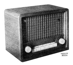
Fig. 5. Hochfrequenz-Telephonrundspruchempfänger
