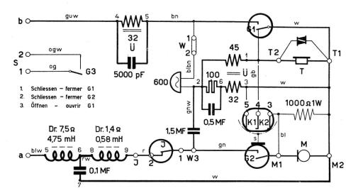
Fig. 15a. Station de table modèle PTT 1950 pour TD-HF
