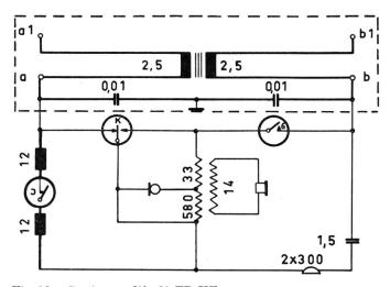
Fig. 13a. Station modèle 29 TD-HF Les éléments antiparasites sont raccordés par des traits gras et les contacts perturbateurs entourés d'un cercle
