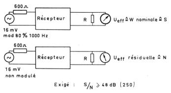
Fig. 11. Mesure du bruit propre des récepteurs (Souffle plus ronflement mesuré avec indicateur de tension efficace, par exemple psophomètre, dans la position «plat»)
