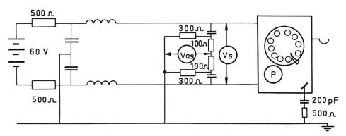
Fig. 10a. Mesure des perturbations dues aux stations téléphoniques (Le circuit série composé d'un condensateur de 200  $\mu$ F et d'une résistance de 500  $\Omega$  situé à droite de la figure est appelé «main artificielle», il relie la masse du téléphone à celle du dispositif de mesure lorsque le téléphone a des
