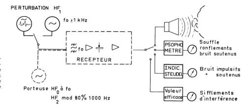
Fig. 3 La tension perturbatrice est comparée, soit à la valeur efficace d'une porteuse non modulée  $\mathrm{HF_1}$  distante de  $1000~\mathrm{Hz}$  de la porteuse utile  $\mathrm{HF_0}$ , soit à la valeur efficace  $\mathrm{HF_2}$  d'une porteuse de fréquence  $f_0$  modulée au taux de 80% à  $1000~\mathrm{Hz}$
