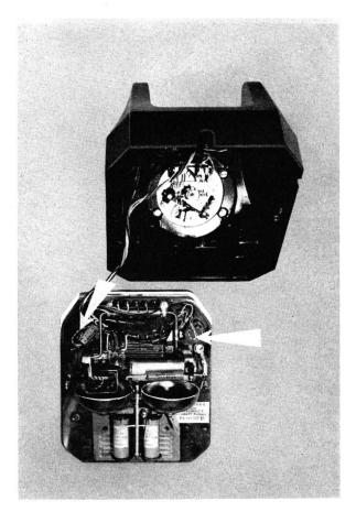
Fig. 15b. Station de table modèle PTT 1950 pour TD-HF (Les éléments antiparasites désignés par les flèches ont été incorporés à la station dès l'origine)
