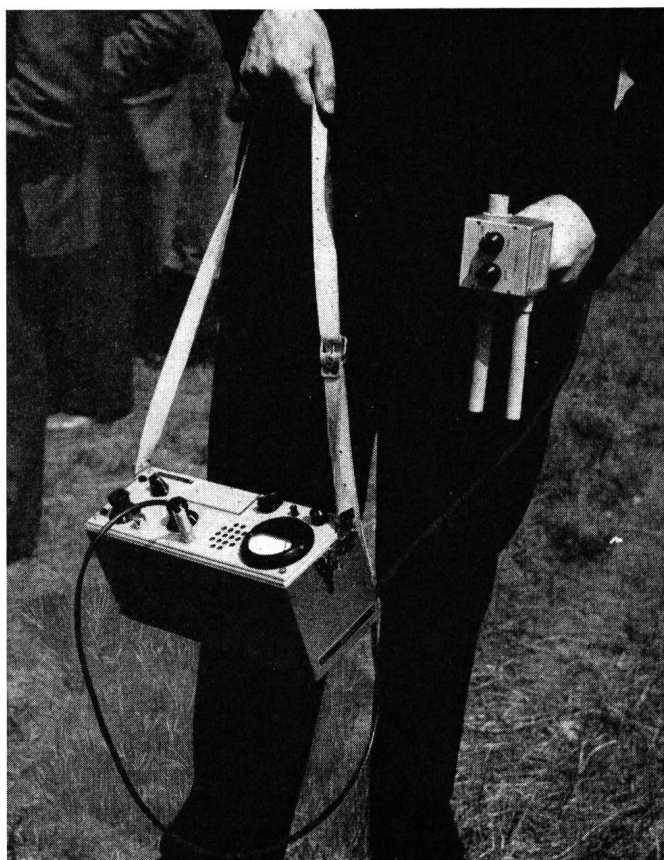
Fig. 4b. Récepteur à transistors conforme aux recommandations du CISPR
