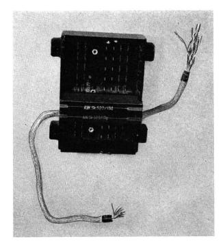
Fig. 16. Boîte pour filtres de central et aiguilles de liaison pour la TD-HF (à gauche, câble relié au central, à droite, départ des
