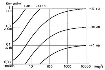
Fig. 5. Réponse du récepteur CISPR aux impulsions brèves régulières (100 imp/s de 0,316  $\mu$ Vs  $\cong$  1 mVeff sinus) en fonction de leur fréquence et de leur amplitude. Chacune des courbes tracées représente l'élongation maximum de l'instrument indicateur obtenue en maintenant constante l'amplitude des impulsions et en faisant varier leur fréquence de répétition. Le niveau relatif des impulsions à l'entrée du récepteur est indiqué en dB à l'extrémité droite de chaque courbe
