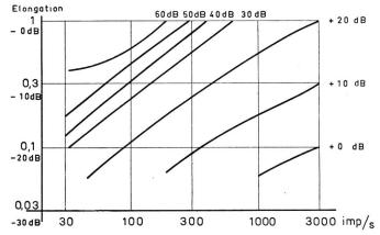
Fig. 7. Réponse du psophomètre CCIF dans la position «filtre musique» aux impulsions brèves ( $20~\mu s$ ) régulières. Lorsque les impulsions sont trop rares, l'indication de l'instrument de sortie n'est pas proportionnelle à l'amplitude des impulsions à l'entrée du psophomètre
