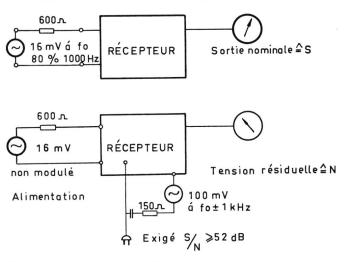
Fig. 12. Mesure de la sensibilité des récepteurs aux perturbations du réseau d'alimentation
