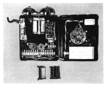
Fig. 13b. Ancienne station murale (En dessous de la station: éléments utilisés pour la déparasiter)
