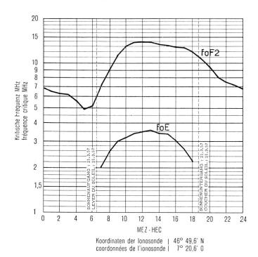
Messung von 1 bis 25 MHz in 30 sek. mesure de 1 à 25 MHz en 30 sec.
