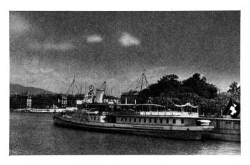
Fig. 7. Vue générale du «Genève» avec une caméra de prise de vue à l'arrière et l'émetteur de la liaison à faisceaux dirigés devant la cheminée
