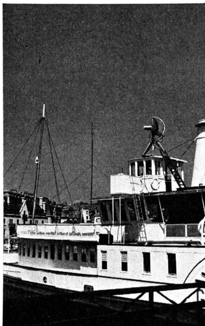
Fig. 8. Photo montrant le système de réglage transformé afin de permettre une orientation plus facile du réflecteur parabolique. Entre le mât et la timonerie, on peut remarquer l'antenne de la liaison à ondes ultra-courtes de contrôle
