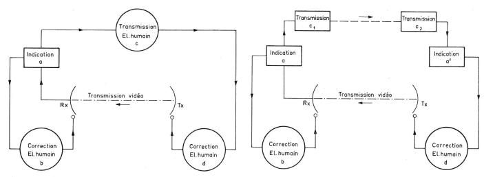
Fig. 1. Principe d'une transmission de télévision par liaison à faisceaux dirigés. Cas général du réglage pour deux stations fixes
