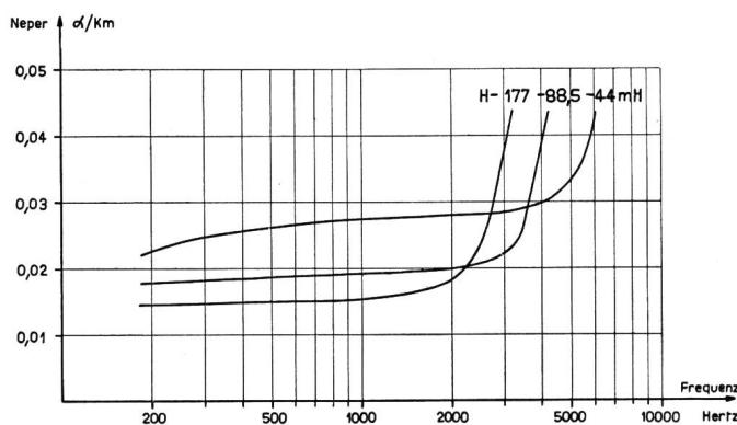
Fig. 1. Dämpfungskurven von Stammleitungen 1,0 mm für verschiedene Belastungen
