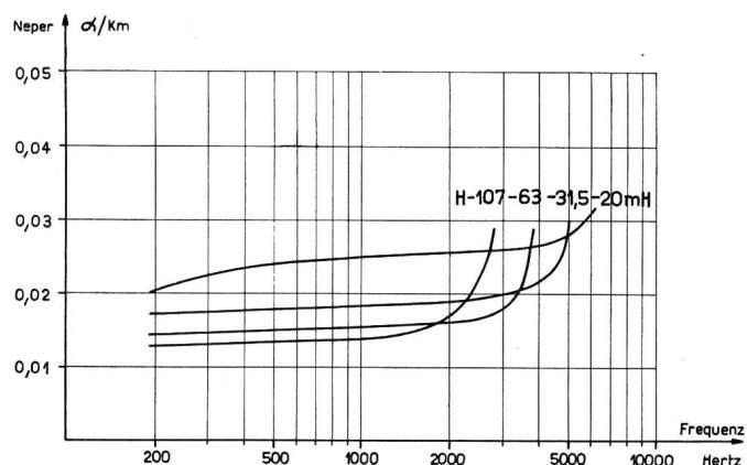
Fig. 2. Dämpfungskurven von DM-Phantomstromkreisen 1,0 mm für verschiedene Pupinisierungen
