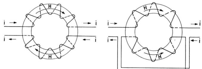
Fig. 8. Links aktive und rechts inaktive Beschaltung von Pupinspulen
