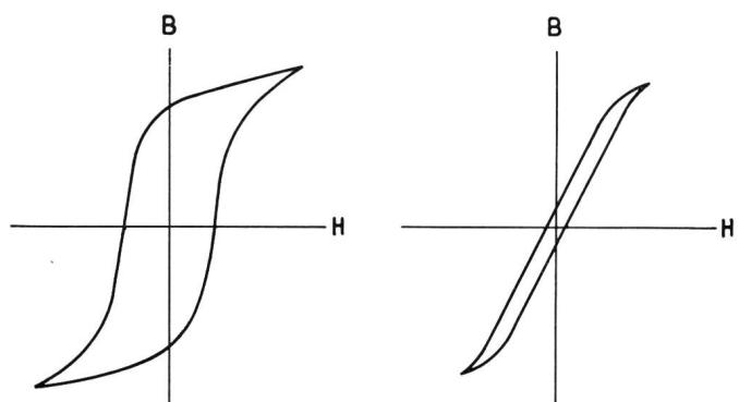
Fig. 4. Hysteresisschleifen von Transformatoren (links) und Pupinkernmaterial (rechts)
