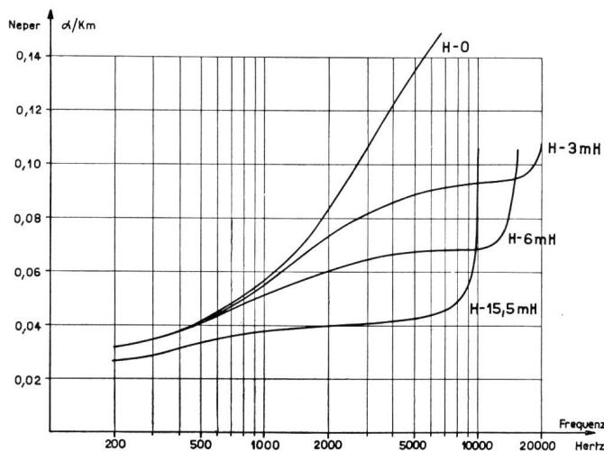
Fig. 7. Dämpfungskurven von verschiedenen pupinisierten Rundspruchleitungen 1,0 mm
