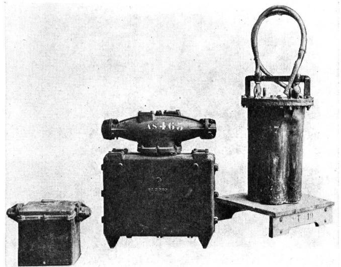
Fig. 6. Verschiedene Ausführungen von Pupinkästen. Bei den zwei ersten Modellen wird das zu pupinisierende Kabel im oberen Teil des Kastens mit den Anschlussdrähten der Pupinspulen verbunden. Beim Kasten rechts bilden zwei Anschlusskabel die Verbindung zwischen Pupinspule und Fernkabel
