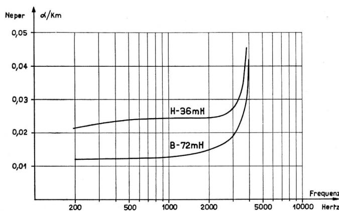
Fig. 3. Dämpfungskurven von Stern-Phantomstromkreisen 1,0 mm für verschiedene Pupinisierungen
