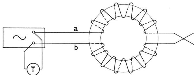
Fig. 9. Prüfen der richtigen Anschlüsse einer Stammpupinspule
