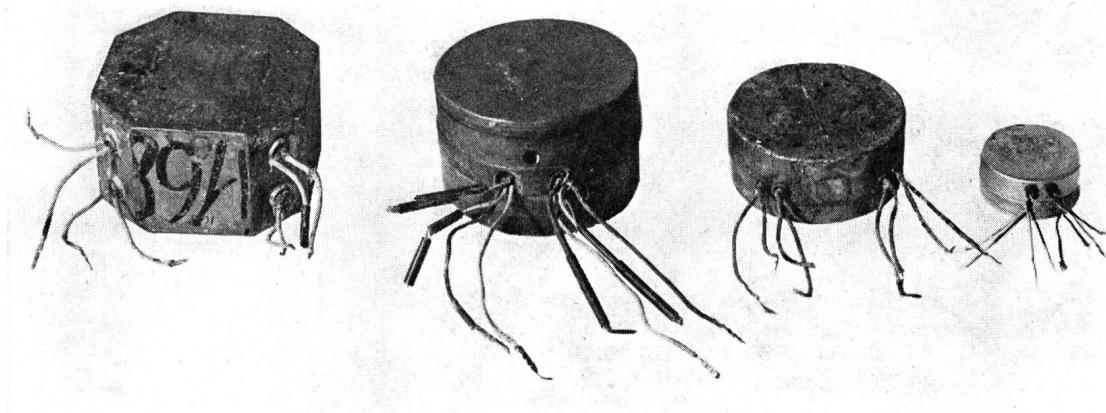
Fig. 5b. Verschiedene Typen von Phantompupinspulen. Das Gewicht der grossen Spule links beträgt bei einer Induktivität von 107 mH 6,46 kg, dasjenige der kleinen Spule rechts bei 31,5 mH noch 410 g
