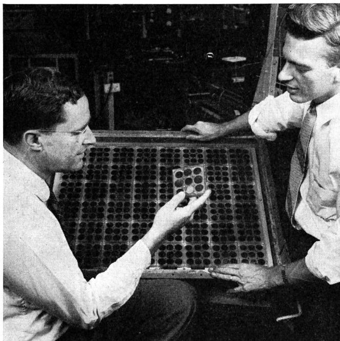
Fig. 1. Die in Neunergruppen zusammengefassten Siliziumzellen werden je nach Bedarf zu einer Sonnenbatterie zusammengebaut. 432 solcher Zellen bauen die Sonnenbatterie auf, die ein Telefonieträgersystem mit der nötigen Energie versieht
