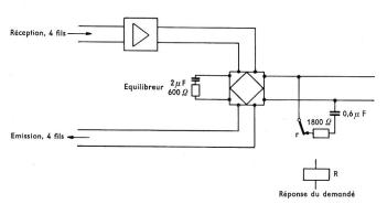
1c) Mise en parallèle d'une impédance de terminaison sur la partie 2 fils de la connexion
