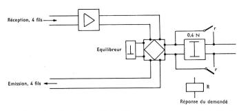
1b) Insertion d'une ligne d'affaiblissement sur la partie 2 fils de la connexion
