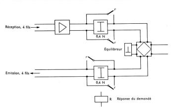
1a) Insertion d'une ligne d'affaiblissement sur chacune des voies de la partie 4 fils de la connexion
