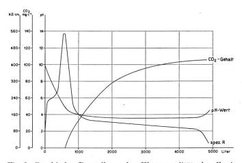
Fig. 2. Graphische Darstellung der Wasserqualität des Zweisäulenentsalzers ME II/90 der Fa. Maestrolit AG., Basel
