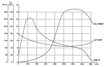
Fig. 3. Graphische Darstellung der Wasserqualität eines Viersäulenentsalzers
