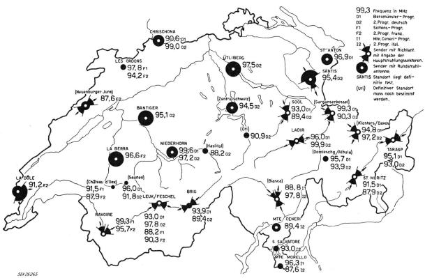
Fig. 13. Mutmasslicher Ausbau des schweizerischen FM-UKW-Netzes
