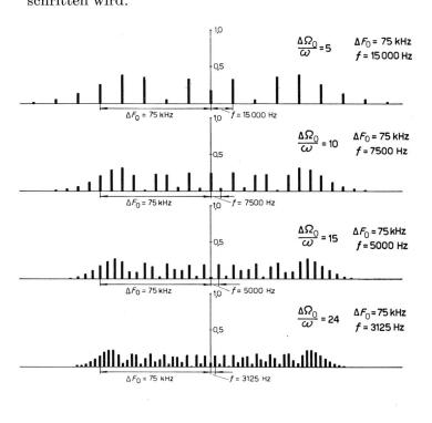
Fig. 1. Seitenbandspektren von FM-Schwingungen links: bei konstanter Modulationsfrequenz f = 5000 Hz und verschiedenen Frequenzhüben  $\Delta F_0$ rechts: bei konstantem Frequenzhub  $\Delta F_0 = 75 \text{ kHz}$  und verschiedenen Modulationsfrequenzen f  $\varDelta \Omega_0$  Frequenzhub;  $\omega$  Kreisfrequenz der modulierenden Schwingung
