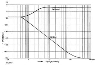
Fig. 7. Störabstand eines FM-Ballempfängers
