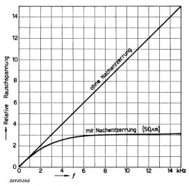
Fig. 8. Rauschspektrum eines FM-Empfängers
