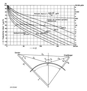
Fig. 10. CCIR-Propagationskurven. Quadratische Mittelwerte. bezogen auf einen Halbwellen-Sendedipol und 1 kW Strahlungsleistung.
