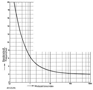
Fig. 2. Bandbreite eines FM-Signals, die alle Seitenbandfrequenzen, deren Amplituden grösser als  $1\,\%$  der unmodulierten Trägeramplitude sind, enthält
