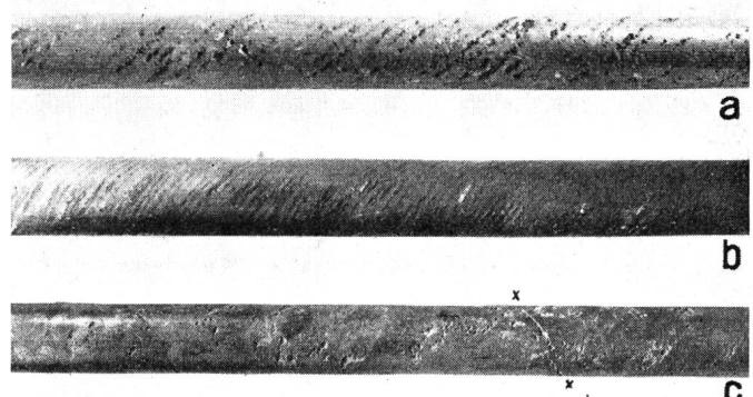
Fig. 13. a) Fortgeschrittene «Phenolkorrosion» mit deutlich spiralen Anfressungen.  $\frac{1}{2}$  nat. Grösse
