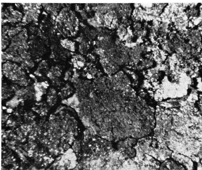
Fig. 3. Intercristalliner Angriff auf der Oberfläche eines Bleimantels nach fünf Tagen in «Hellerscher Lösung». Vergr. 30×
