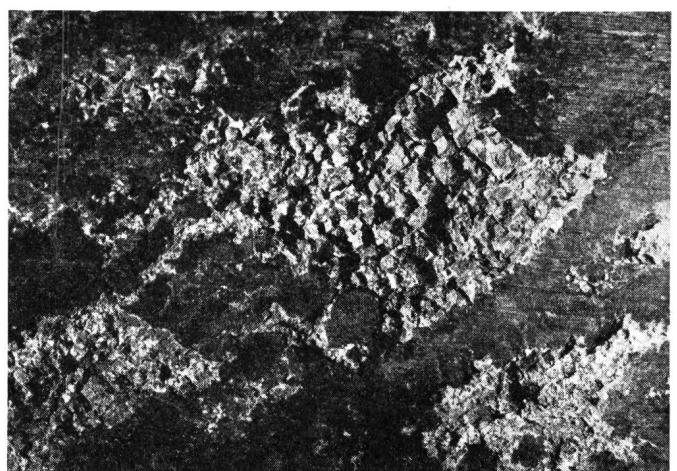
Fig. 14. «Phenolkorrosion». Nester interkristallinen Zerfalls des Bleigefüges. Vergr. 4×
