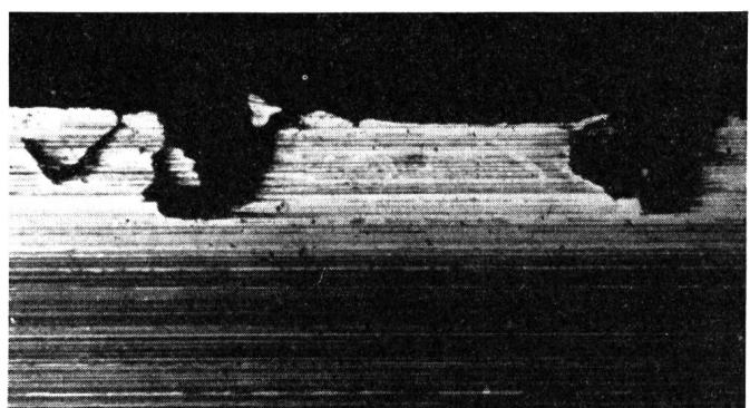
Fig. 11. Eng begrenzte Korrosionen unter bituminisierten Juteschnüren (Versuch: Blei + bituminisierte Jute). Vergr. 45 $\times$
