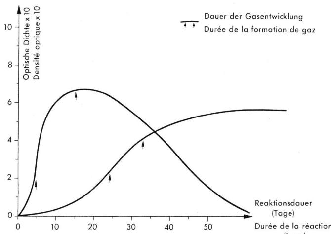
Fig. 1. Verlauf der Gelbfärbung der «Hellerschen Lösung» bei zwei verschiedenen, unlegierten Bleiproben, gemessen mit einem «Clinical Analyzer» und Blaulicht (440 μ).
