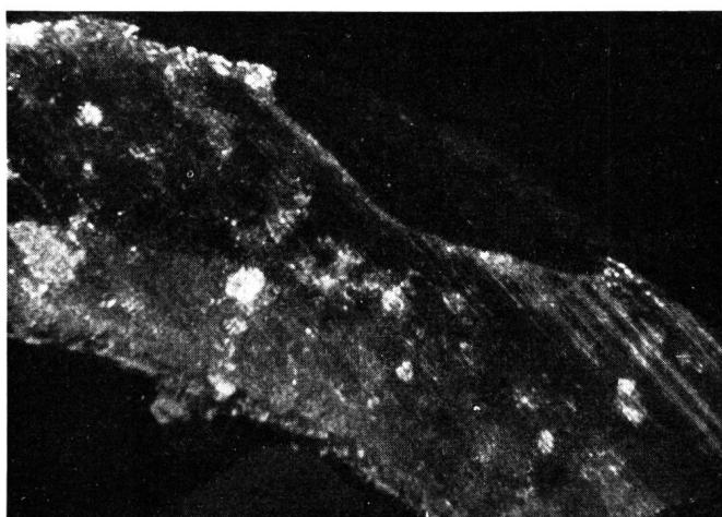
Fig. 5. An einem dünnen Kabel (Durchmesser 1 cm), das während einer Woche in «Hellerscher Lösung» lag, konnten starke lokale, elektrolytische Anfressungen infolge Elementbildung beobachtet werden (vgl. auch Fig. 6). Der Schnitt lässt die typische Kraterform gut erkennen. Die Innenseite zeigt normale, interkristalline Korrosion. Vergr. 30×
