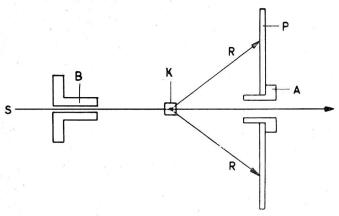
Fig. 3. Versuchsanordnung für das Aufnahmeverfahren nach  $von\ Laue$
