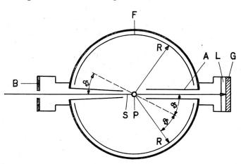
Fig. 5. Versuchsanordnung für das Pulververfahren nach Debye-Scherrer
