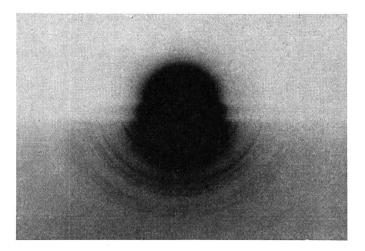
Fig. 19. Streifende Elektronenbeugungsaufnahme von rotem Bleioxyd auf Blei
