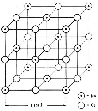
Fig. 16. Gitterzelle von Natriumchlorid
