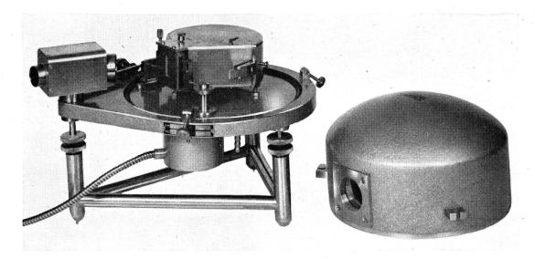
Fig. 13. Guinier-Kammer mit Vakuumhaube (Nonius, Delft)
