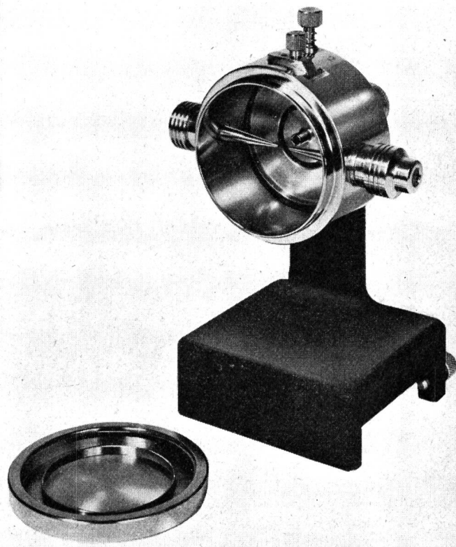
Fig. 6. Debye-Scherrer -Kammer (Philips)
