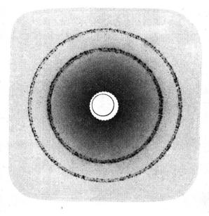
Fig. 18. Rückstrahlaufnahme von geglühtem Kupferblech
