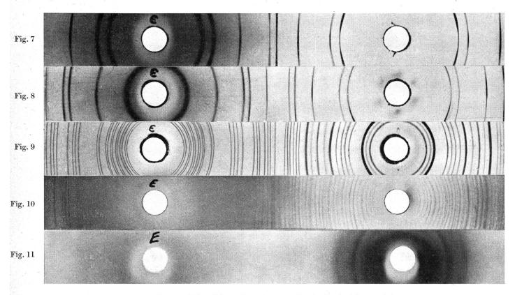
Fig. 7. Debye-Scherrer-Diagramm von Kupfer (Draht  $0.3 \,\mathrm{mm} \,\varnothing$ )
