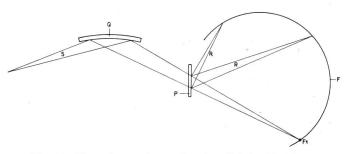
Fig. 12. Versuchsanordnung für das Guinier-Verfahren
