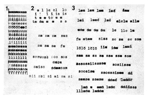
Fig. 2. Exemples de typo-sonogrammes ou phonétogrammes (1952) délivrés par le phonétographe, prototype I
