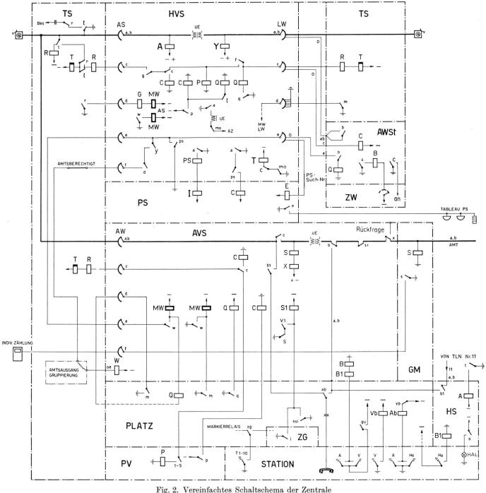
Fig. 2. Vereinfachtes Schaltschema der Zentrale
