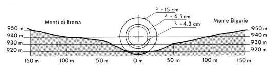
Fig. 4. Détail de la coupe de terrain aux Monti di Brena perpendiculairement au faisceau d'ondes hertziennes. On remarquera la place occupée par la première zone de Fresnel pour les différentes longueurs d'onde
