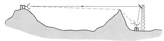
Fig. 2. Principe du relais passif. Le réflecteur est ici disposé au sommet d'une tour. En pointillé le trajet du rayon diffracté Principio del ripetitore passivo. Il riflettore è disposto sul culmine della torre. La linea punteggiata indica il percorso del
