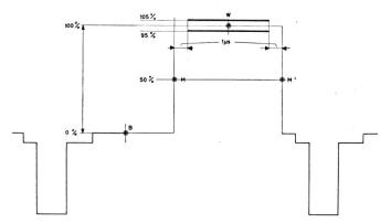
Fig. 7. Toleranzschema für den Einschwingvorgang im mittleren Frequenzbereich einer Fernsehleitung. Zur Illustration ist der Idealfall eingezeichnet
