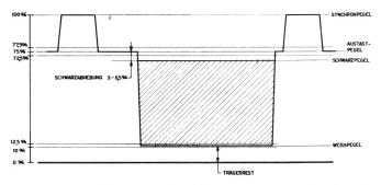
Fig. 4. Pegelverhältnisse des hochfrequent ausgestrahlten Signals. (Es ist nur die positive Enveloppe gezeichnet.)
