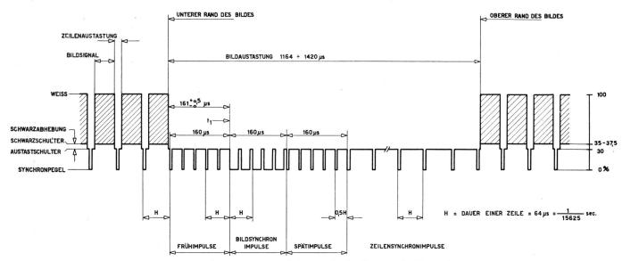
Fig. 2. Impulsfahrplan während der Bildlücke des geradzahligen Rasters
