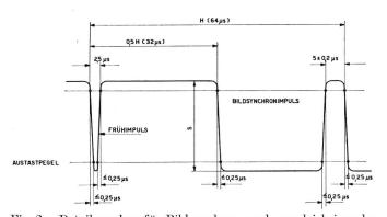
Fig. 2a. Detailangaben für Bildsynchron- und -ausgleichsimpulse
