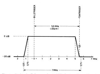
Fig. 4a. Spektrale Belegung des 7 MHz breiten Fernsehkanals
