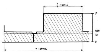
Fig. 11. Form und Verlauf des internationalen Prüfsignales Nr. 1 (Bildaustastung und -synchronisierung sind fakultativ)
