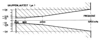
Fig. 10. Toleranzschema für die Gruppenlaufzeit einer gut dimensionierten Fernsehleitung
