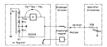
Fig. 9. Prinzip der Phasenbestimmung
