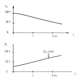
Fig. 17. Verlauf von  $u_3$ und  $u_4,$ wenn die Prüfbürste bei t=0auf die richtige Phase trifft
