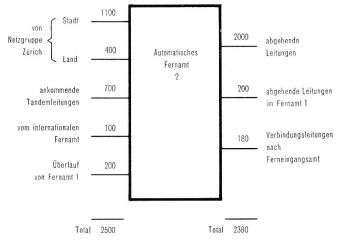
Fig. 2. Kapazität des automatischen Fernamtes 2
