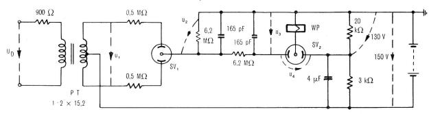
Fig. 11. Schema des Diskriminators
