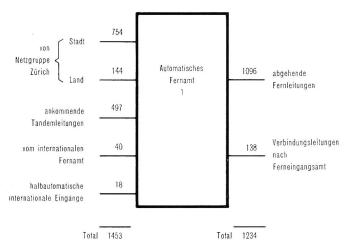
Fig. 1. Belegung des automatischen Fernamtes 1 (1955)
