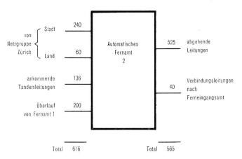
Fig. 3. Erstausbau des automatischen Fernamtes 2
