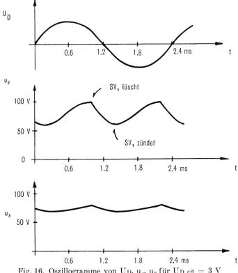
Fig. 16. Oszillogramme von  $U_D$ ,  $u_2$ ,  $u_3$  für  $U_D$  eff = 3 V
