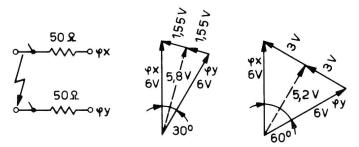
Fig. 10. Wirkung von direkten Schlüssen zwischen zwei Bogenkontakten
