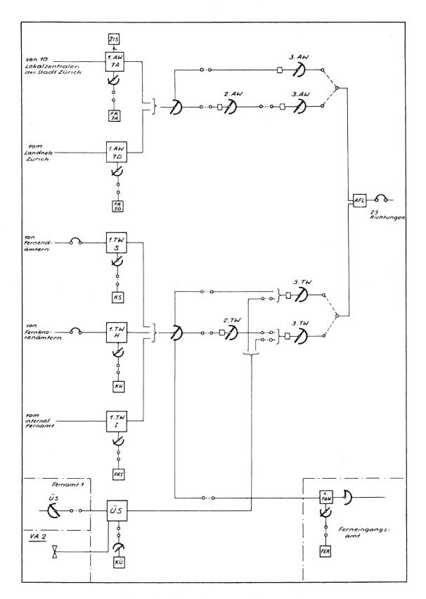
Fig. 4. Verbindungsdiagramm des Fernamtes 2
