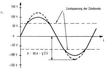
Fig. 14. Verlauf der Spannung u, in Figur 11, wenn  $U_D=3~\mathrm{V}$  ist
