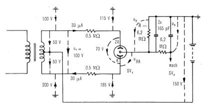
Fig. 15. Spannungen am Diskriminator für  $u_1 = 100 \text{ V}$
