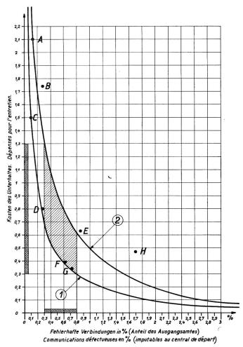
Fig. 2. Centraux automatiques. Courbe de variation de la qualité du service téléphonique interurbain par rapport aux dépenses pour l'entretien.
