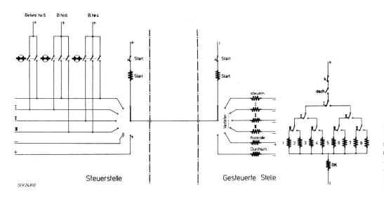
Fig. 3. Steuerung mit Kombinations-schaltung in Verbindung mit synchron laufenden Verteilern. Anzahl Verteilerschritte = n; Anzahl mögliche Kombinationen  $= 2^n$ ; I, II, III . . . Verteilerschritte
