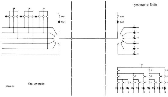
Fig. 4. Kombinationsschaltung, bei der für jede Steuerung gleichviel Impulse verwendet werden. Anzahl Impulse = k; Anzahl Verteilerschritte I, II, III... = n; Anzahl mögliche Kombinationen =  $\binom{n}{k}$  für  $\binom{n=5}{k=3}$   $\binom{n}{k} = \frac{5 \cdot 4 \cdot 3}{1 \cdot 2 \cdot 3} = 10$
