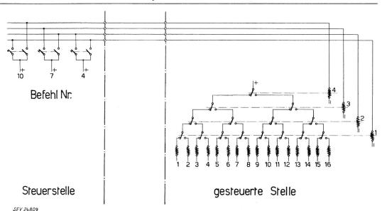
Fig. 2. Steuerung mit Kombinationsschaltung über mehrere Adern. Anzahl Möglichkeiten =  $2^{\text{Anzahl Adern}} = 2^4 = 16$  Befehle über 4 Adern
