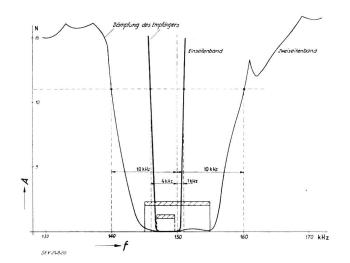
Fig. 3. Selektivität von Zweiseiten- und Einseitenbandgeräten A Dämpfung; f Frequenz
