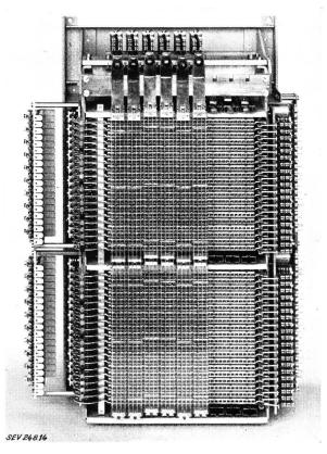
Fig. 7. Kreuzwähler mit 40 Quer- und 6 Längsgliedern
