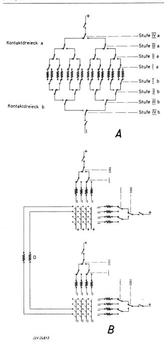
Fig. 6. Rückrechner mit und ohne Kreuzwähler
