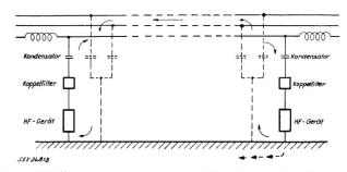
Fig. 1. HF-Übertragungsvorgang bei Einphasenankopplung Die nicht eingekoppelten Leiter sind über die Streukapazität Leiter-Erde an der Rückleitung beteiligt
