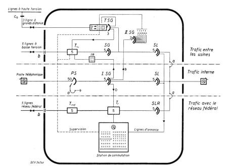
Fig. 2 Plan d'acheminement d'un central téléphonique
