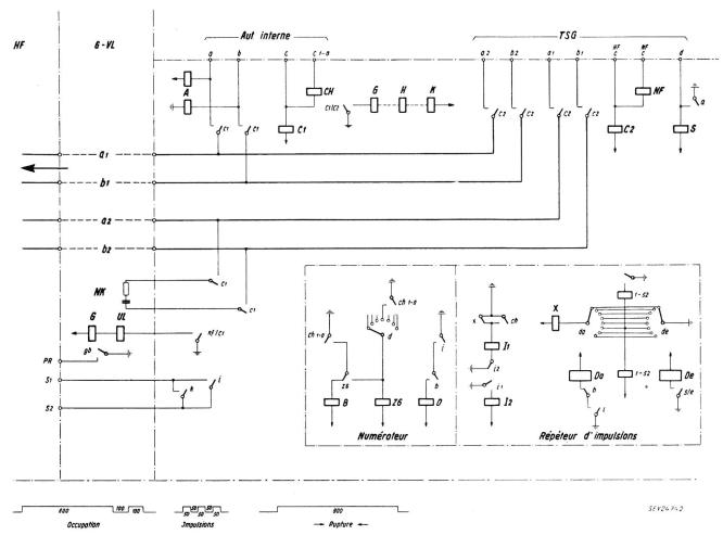
Fig. 4. Trafic sortant du TGW HF Lignes à haute tension; G—VL Différentiel-Affaiblissement; TSG Sélecteurs de groupe tandem; NK Equilibreur; NF Lignes à basse tension
