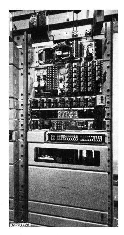
Fig. 3 Bâti de translateurs et sélecteurs tandems avec les couvercles de protection en partie enlevés
