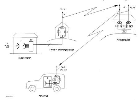
Fig. 5. Drahtlose Telephonanlage für den Verkehr mit Fahrzeugen
