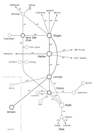
Fig. 2. Werktelephonnetz der ATEL
