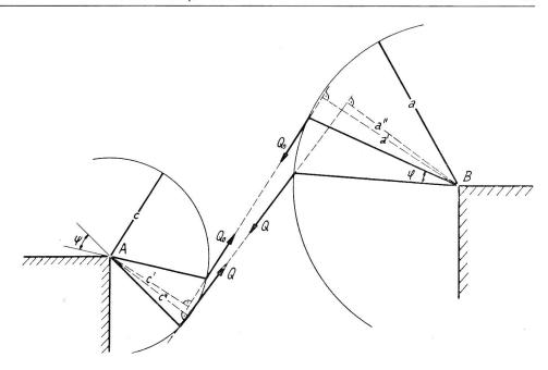
Fig. 7. Verhältnis der Bewegungen von Joch (Drehpunkt bei B) und Gehänge (Drehpunkt bei A)
