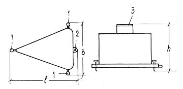
Fig. 5. Schematischer Grund- und Aufriss des Vertikalpendels
