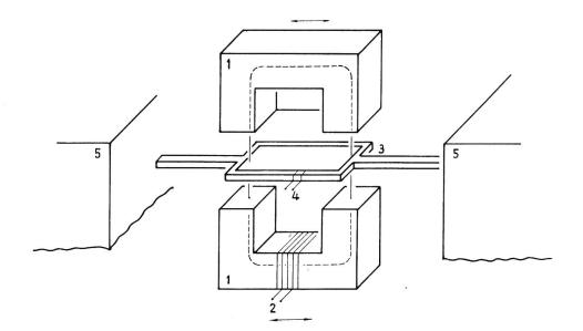
Fig. 1. Prinzipschema des elektromechanischen Umformers
