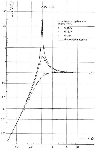
Fig. 10. Ergebnisse der dynamischen Prüfung des Vertikalpendels auf dem Schütteltisch im Vergleich zu den theoretischen Sollwerten
