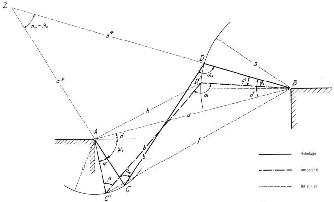
Fig. 8. Geometrie des Schwingers
