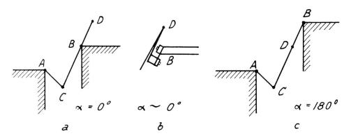
Fig. 9 Spezialfälle der Aufhängung des Schwingers im Rahmen
