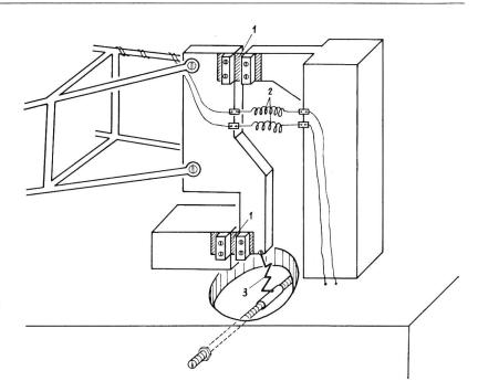
Fig. 2. Verbindungen zwischen Schwinger und Rahmen beim Horizontalpendel
