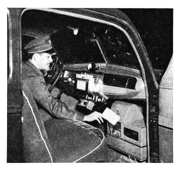
Fig. 7. Innenansicht eines Telecars (Zustellautomobils). Rechts, vor dem Chauffeur, der Faksimileapparat
