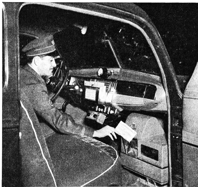
Fig. 7. Innenansicht eines Telecars (Zustellautomobils). Rechts, vor dem Chauffeur, der Faksimileapparat Intérieur d'un télécar (automobile de distribution). A droite, devant le conducteur, l'appareil fac-similé
