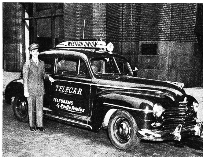
Fig. 6. Zustellautomobil mit Antenne und Faksimileapparat für den drahtlosen Empfang von Telegrammen vom Haupttelegraphenamt während der Fahrt
