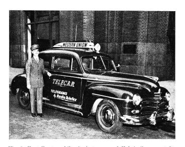
Fig. 6. Zustellautomobil mit Antenne und Faksimileapparat für den drahtlosen Empfang von Telegrammen vom Haupttelegraphenamt während der Fahrt Automobile de distribution équipée d'une antenne et d'un appareil fac-similé permettant la réception radioélectrique, pendant la marche, des télégrammes provenant de l'office
