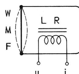
Das Telefon ist charakterisiert durch die elektrischen Größen  $L$  und  $R$  und durch Masse  $M$ , Widerstand  $W$  und Federung  $F$  der Membran und des dahinter liegenden Luftpolsters. Mit dem elektromechanischen
