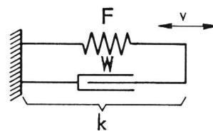
Als Güte eines schwingungsfähigen Gebildes (Resonanzkreis) wird das Verhältnis Blindleistung/Wirkleistung bei der Resonanzfrequenz bezeichnet, das für den mechanischen Parallelkreis durch
