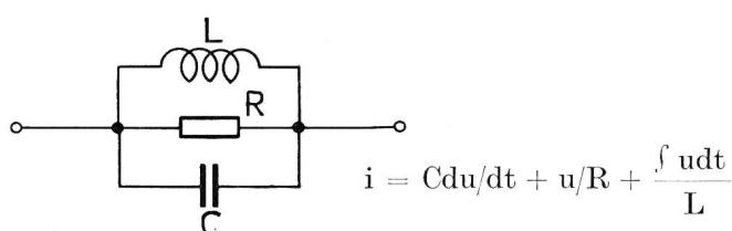
Das mechanische Analogon zum elektrischen Serienkreis ist derjenige mechanische «Kreis», bei dem alle Elemente vom gleichen «Strom» durchflossen werden, also bei Benutzung der Analogie I ( $i \sim v$ ) die gleiche Geschwindigkeit haben. Das ist beim mechanischen Parallelkreis der Fall.
