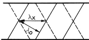
Interessiert nur der Betrag des Reflexionsfaktors, so ist es bei dieser Messanordnung unter Umständen günstiger, mit Impulsen zu arbeiten, wobei, um die Dämpfung längs des Rohres sofort zu eliminieren, das Objekt mit einem vollständig reflektierenden (schallweichen) Reflektor gleicher Grösse verglichen wird, der vorher oder nachher an seine Stelle gebracht wird. Wegen der Dispersion breiten sich die Impulse natürlich mit der entsprechenden Gruppengeschwindigkeit
