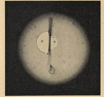
Mikroskopaufnahme einer p-n-p-Doppeljunction
