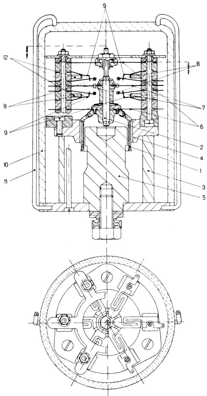
Fig. 2. Konstruktion des Relais im Aufriss und Grundriss
