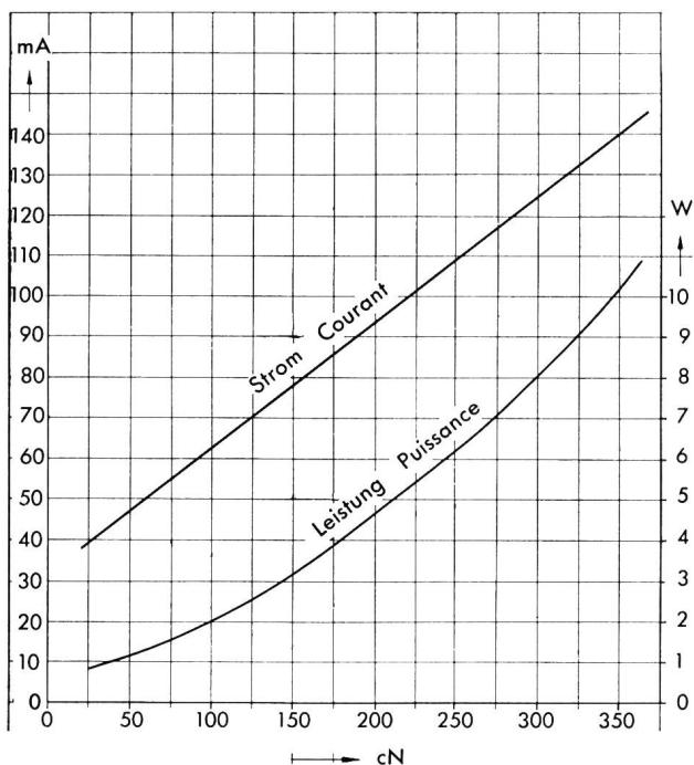
Fig. 3. Zugkraftkurve des elektrodynamischen Relais
