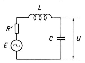
Fig. 3. Elemente des Einzelschwingkreises
