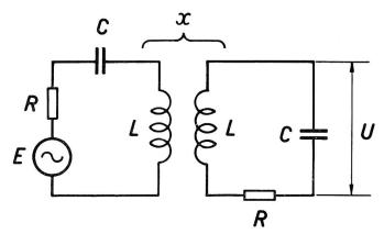
Fig. 1. Prinzipschaltung des zweikreisigen Bandfilters mit induktiver Kopplung
