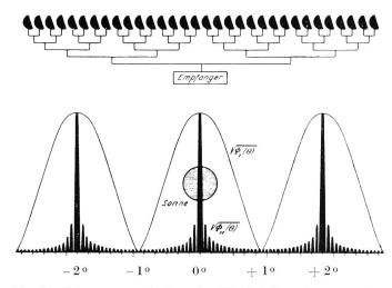
Fig. 12. Schema vom Aufbau des Vielfach-Interferometers für  $\lambda=21$  em der australischen Forschungsgruppe Sidney
