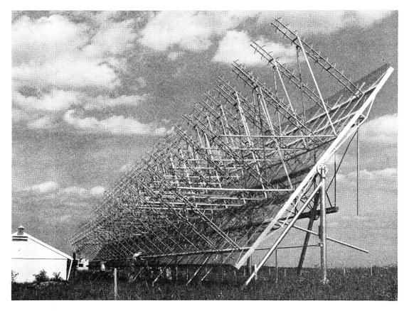
Fig. 7. Spiralantennen-Teleskop für  $\lambda=1,2$  der Universität Ohio
