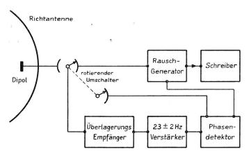
Fig. 16. Blockschema einer radio-astronomischen Empfangsanlage
