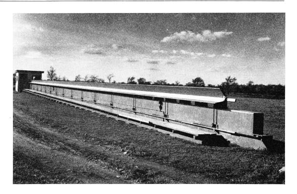
Fig. 14. Hohlleiterteleskop für  $\lambda=10.7$  cm des Forschungslaboratoriums des Nationalen Forschungsrates Ottawa
