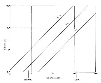
Fig. 3. Halbwertbreite von Parabolspiegeln für verschiedene Spiegeldurchmesser als Parameter als Funktion der Wellenlange
