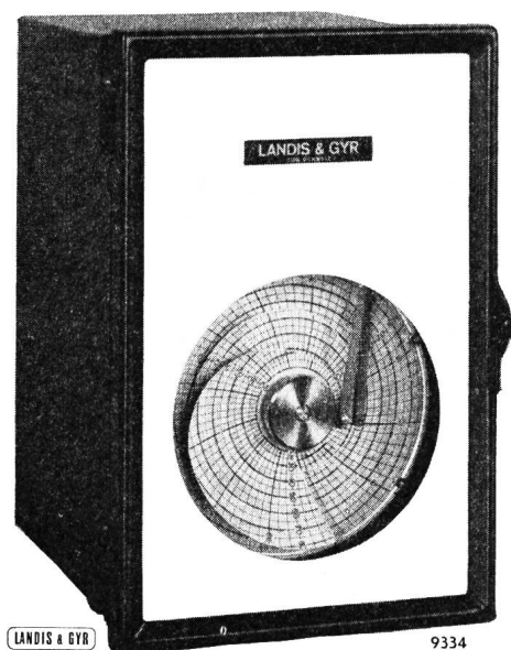
Fig. 11. Programmgeber steuert mit Kurvenscheiben den Verlauf zweier voneinander unabhängiger Grössen (z. B. Temperatur und Feuchtigkeit)
