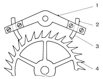
Fig. 1. Grahamgang für Pendeluhren – Système Graham pour pendules
