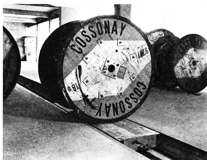
Fig. 2. Schiebebühne mit Kabeltrommel
