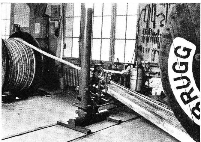
Fig. 5. Kabellängen-Messeinrichtung im Zentralmagazin Ostermundigen. Rechts: im Messgerät eingehängtes Stützbrett
