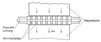
Fig. 5. Konstruktionsprinzip des axial geschichteten Attenuators
