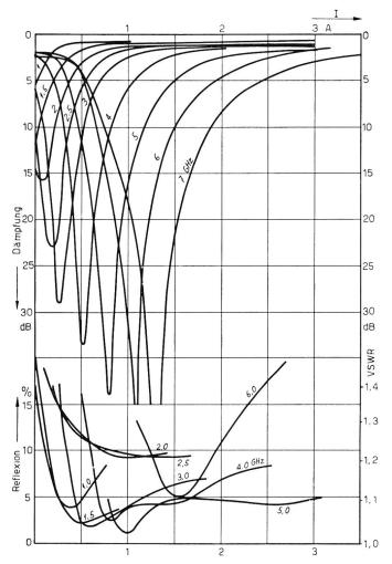
Fig. 7. Dämpfungs- und Reflexionskurven für einen Attenuator nach Fig. 6
