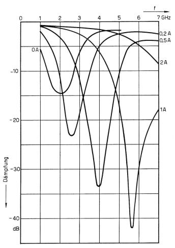
Fig. 8. Frequenzabhängigkeit der Dämpfung eines Attenuators nach Fig. 6
