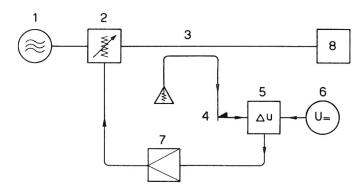
Fig. 10. Amplitudenregelung mit magnetischem Attenuator
