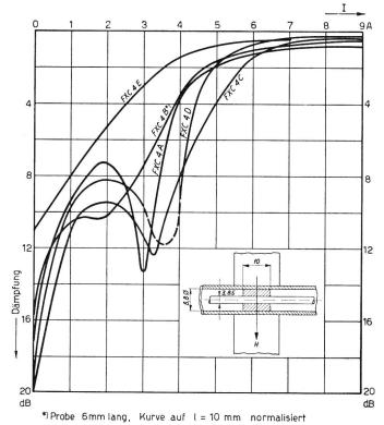
Fig. 3. Gemessene Betriebsdämpfungen verschiedener Ferrite
