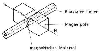
Fig. 1. Prinzipieller Aufbau eines magnetischen Attenuators
