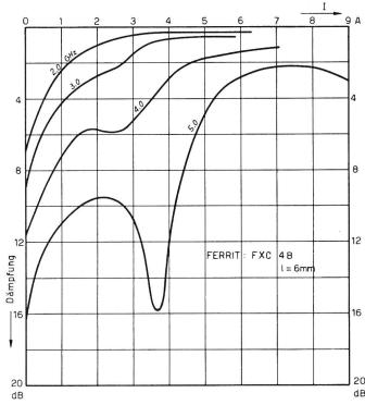
Fig. 4. Frequenzabhängigkeit der Dämpfung einer Ferritprobe
