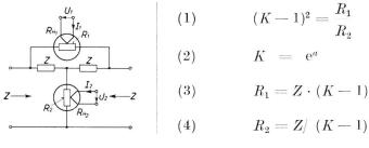
Fig. 11. Überbrücktes T-Glied mit Längs- und Querthermistoren als Stellglied
