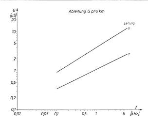
Fig. 7. Kilometrische Ableitung einer zweidrähtigen, hoch verlegten Feldleitung in Abhängigkeit der Frequenz bei trockener und nasser Witterung
