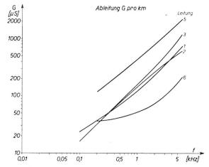
Fig. 6. Kilometrische Ableitung einer zweidrähtigen, am Boden verlegten Feldleitung in Abhängigkeit der Frequenz bei verschiedenen Aderabständen und unterschiedlicher Witterung (siehe Tabelle)
