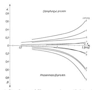
Fig. 4. Dämpfungs- und Phasenmass einer zweidrähtigen Feldleitung in Abhängigkeit der Frequenz bei verschiedener Verlegung, verschiedenen Aderabständen und unterschiedlicher Witterung (siehe Tabelle)
