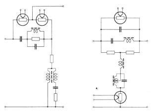
Fig. 12. Entzerrernetzwerk mit Thermistoren Spannungsteilerglied Überbrücktes T-Glied
