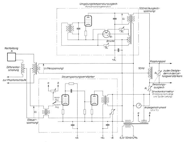
Fig. 8. Übersichtsstromlauf des Steuerspannungsgebers einer Pegelsteuerung
