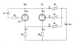
Fig. 16. Übersichtsstromlauf eines Steuergerätes mit künstlicher Begrenzung der Regelung
