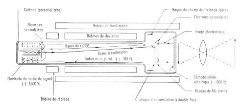
Fig. 15. Orthiconoscope à image électronique (Image-Orthicon)
