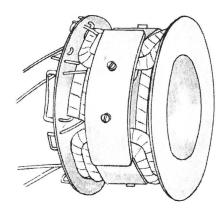
Fig. 7. Bobines pour la déviation magnétique
