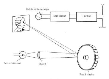
Fig. 3. Emetteur de télévision, analyse de l'image par roue à miroirs
