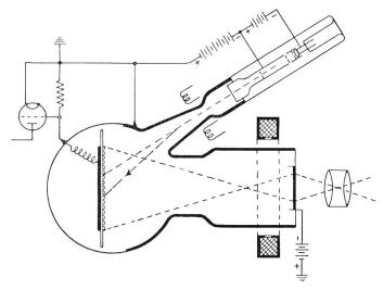
Fig. 13. Schéma d'un super-iconoscope
