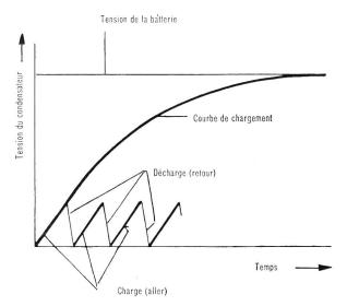
Fig. 22. Courbe exponentielle ascendante de la tension lors du chargement d'un condensateur par l'intermédiaire d'une résistance en série
