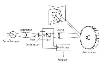
Fig. 4. Récepteur de télévision à roue à miroirs et cellule de Kerr
