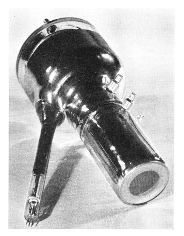
Fig. 14. Vue d'un tube super-iconoscope
