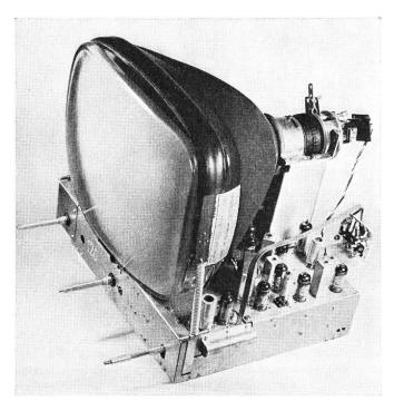
Fig. 19. Vue du châssis d'un récepteur de télévision
