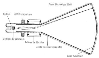
Fig. 5. Tube à rayons cathodiques
