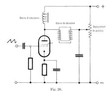
Amplificateur servant à produire le courant en dents de scie
