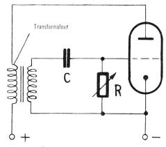
Fig. 24. Oscillateur de blocage
