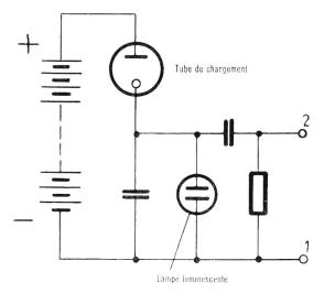
Fig. 23. Schéma d'un générateur d'oscillations de relaxation à lampe luminescente
