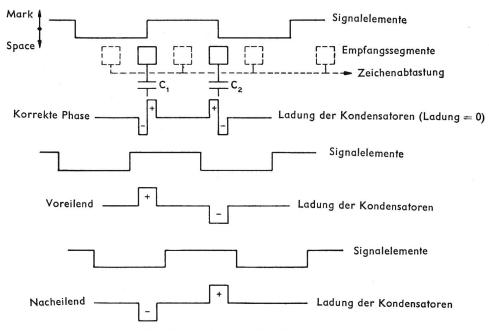
Fig. 6. Abtastung im Empfangsverteiler
