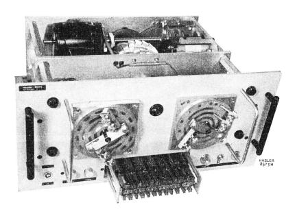
Fig. 4. Verteilereinheit des Zweikanal-TOR
